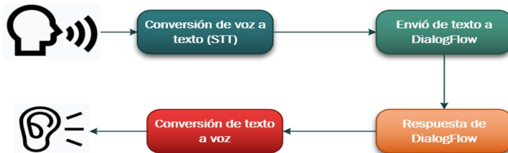
**Figura 23.** Esquema de funcionamiento del Sistema de dialogo
