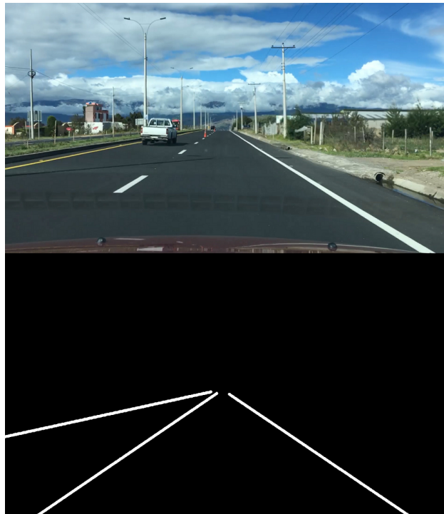
Figura 1. Segmentación de imágenes: Las líneas horizontales de la carretera de la imagen superior se han segmentado y se ha generado la máscara de la imagen inferior
