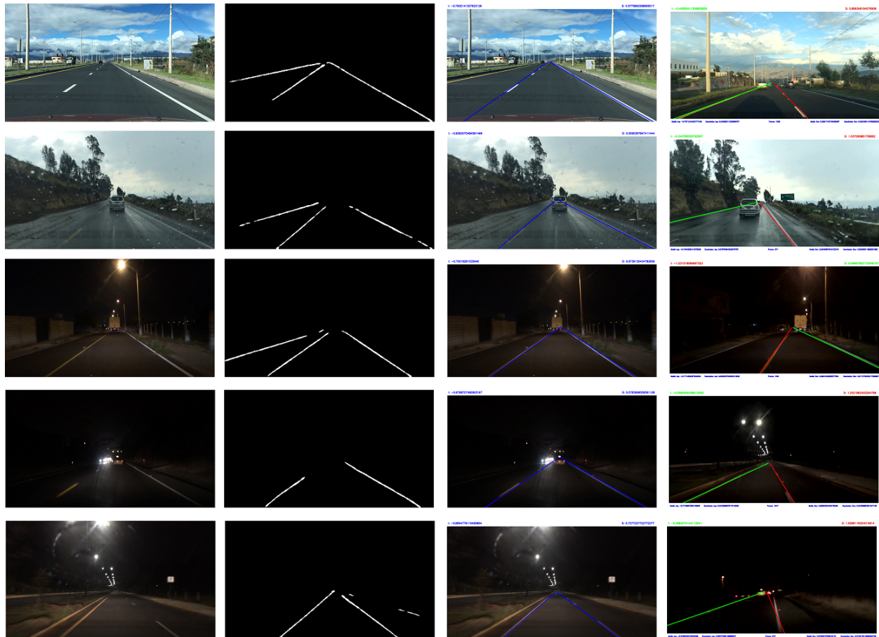
Figura 33. Resultados generados por la red neuronal. Cada fila es un escenario diferente. La segunda columna es la máscara generada por la red neuronal, la tercera es el resultado final (en calibración) y la cuarta es el sistema detectando cuando el vehículo pierde la trayectoria correcta
