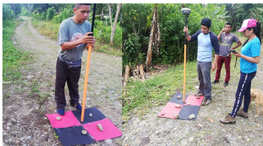
Figura 18. Medición de puntos con el método RTK
