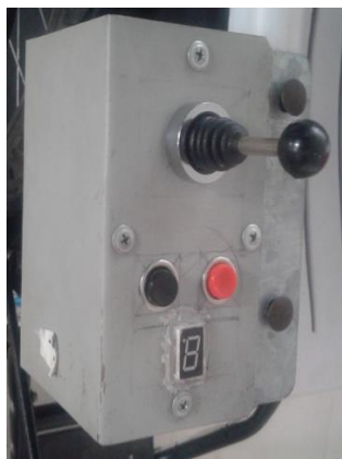
Figura 65. Caja de Control de Velocidad y Movimiento
