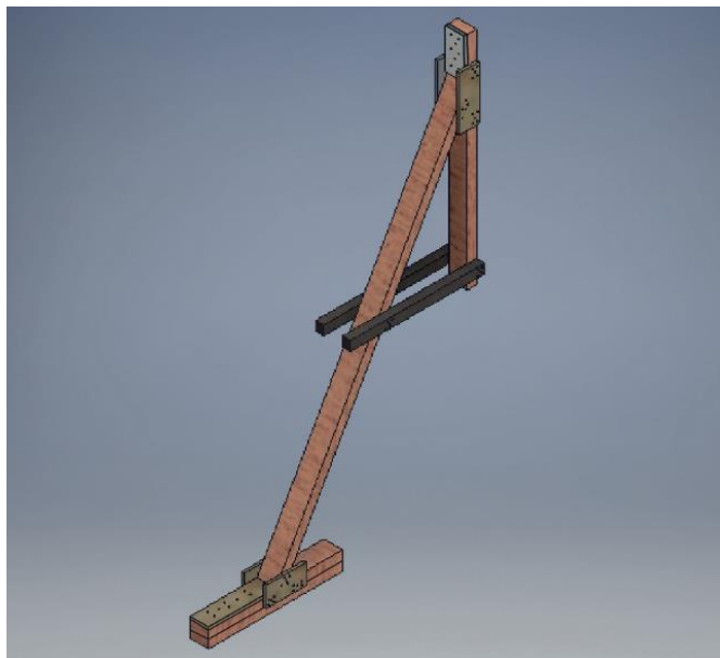
Figura 25. Apuntalamiento Inclinado a fricción
