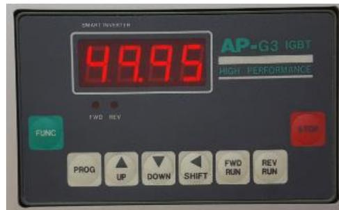
*Figura 52.* Encendido del panel del variador de frecuencia.
