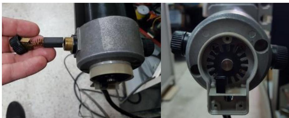
*Figura 58.* Verificación de los carbones y encoder del motorreductor DC.
