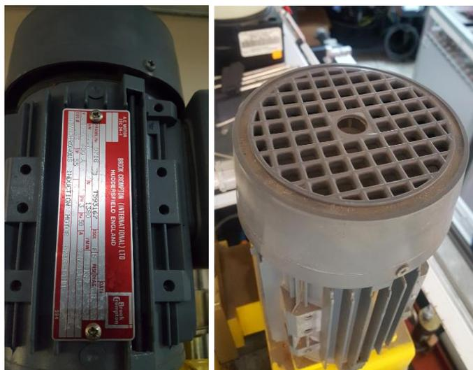
**Figura 50.** Motor AC trifásico asíncrono de la fresadora
