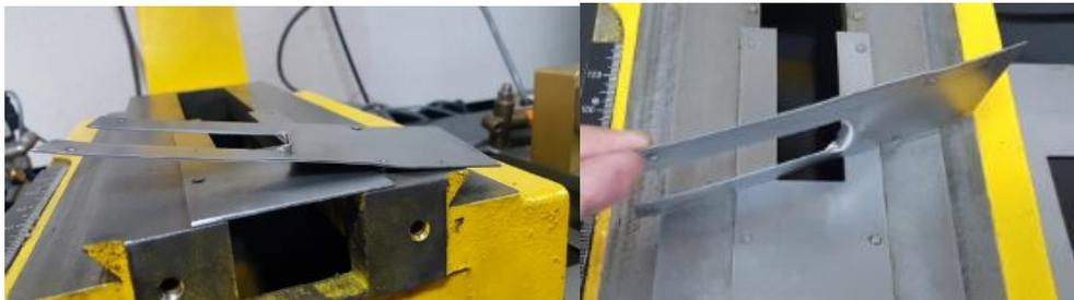
**Figura 67.** Placa de deslizamiento doblada de la fresadora.
