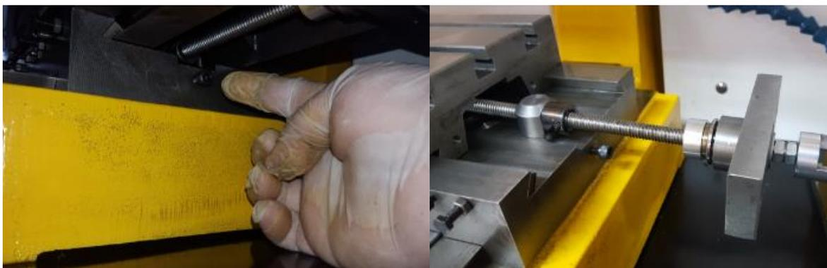
**Figura 71.** Ajuste del carro transversal de la fresadora
