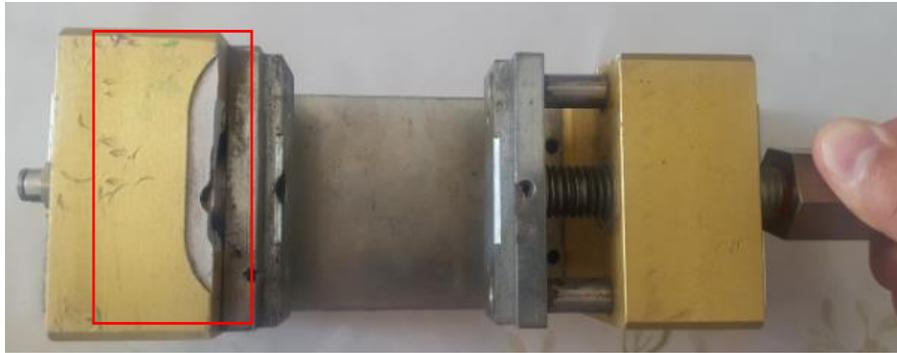
**Figura 44.** Daño en el pistón de agarre de la fresadora
