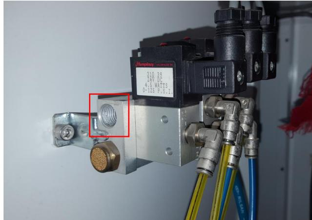
**Figura 22.** Electroválvulas de la fresadora no cuentan con tapones.
