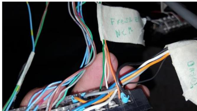
**Figura 23.** Cableado desconectado de las electroválvulas y finales de carrera.
