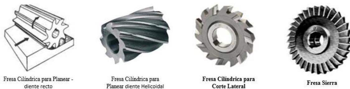
**Figura 6.** Clasificación de fresas conforme el trabajo específico en fresadoras horizontales
