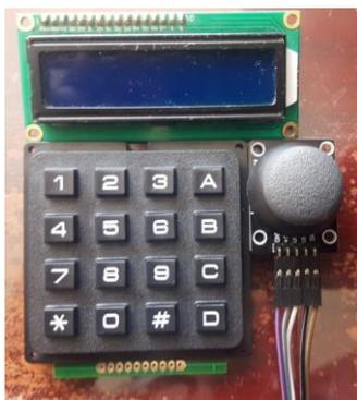
**Figura 146.** Componentes de entrada y salida de información del mando FMS 2101.
