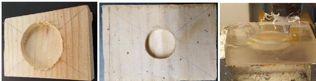
**Figura 165.** Circunferencias fresadas en un rectángulo de madera y acrílico.
