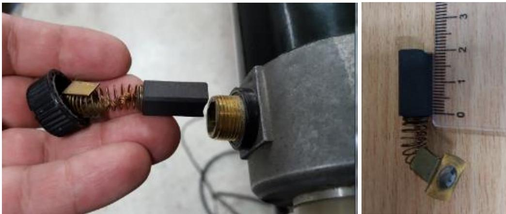
*Figura 74.* Carbones del motorreductor del riel.
