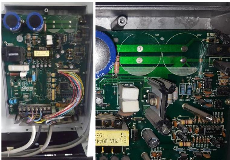
*Figura 48.* PCB y daños del variador de frecuencia
