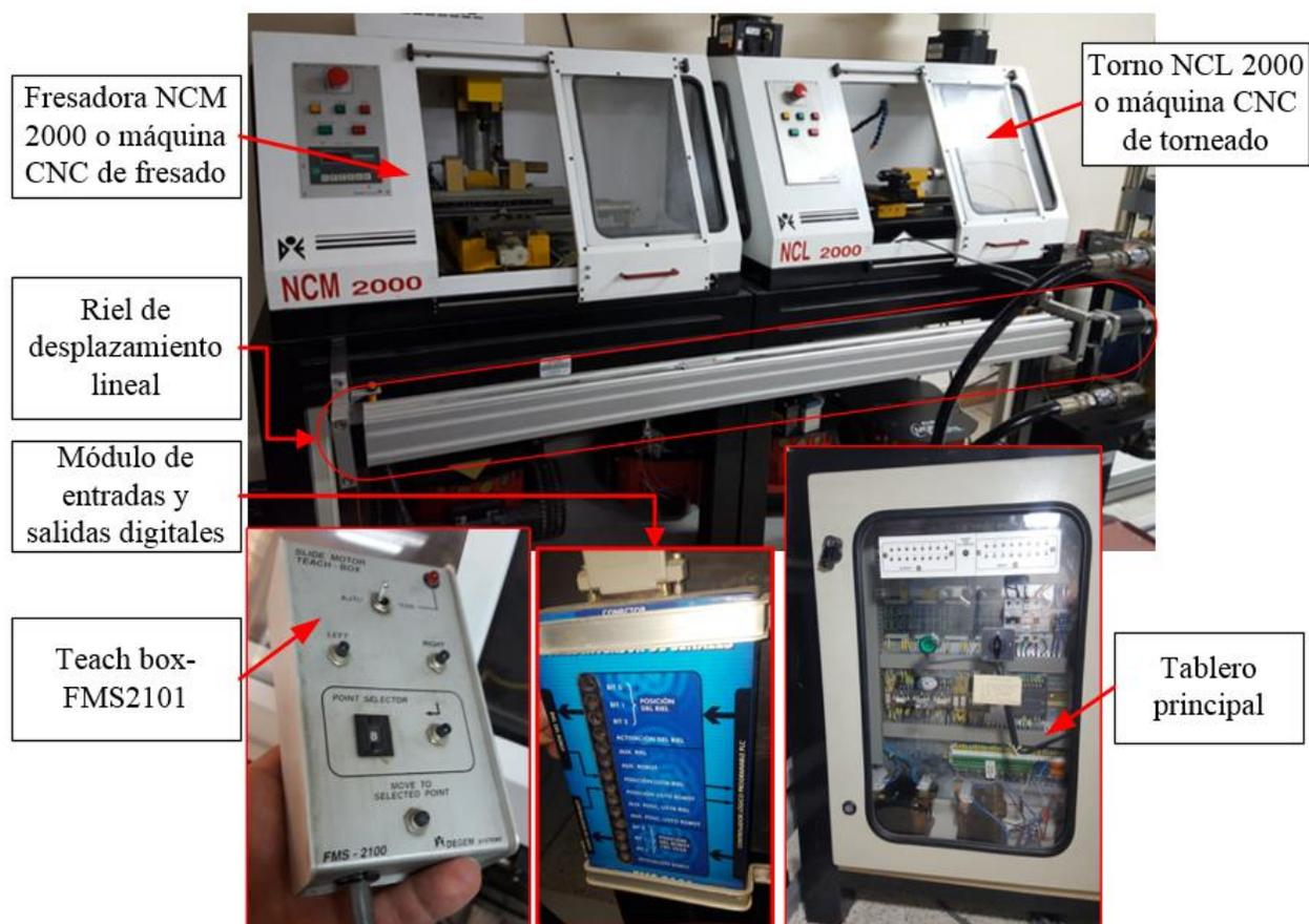
**Figura 17.** Componentes generales antes de la repotenciación de la estación FMS 2101.
