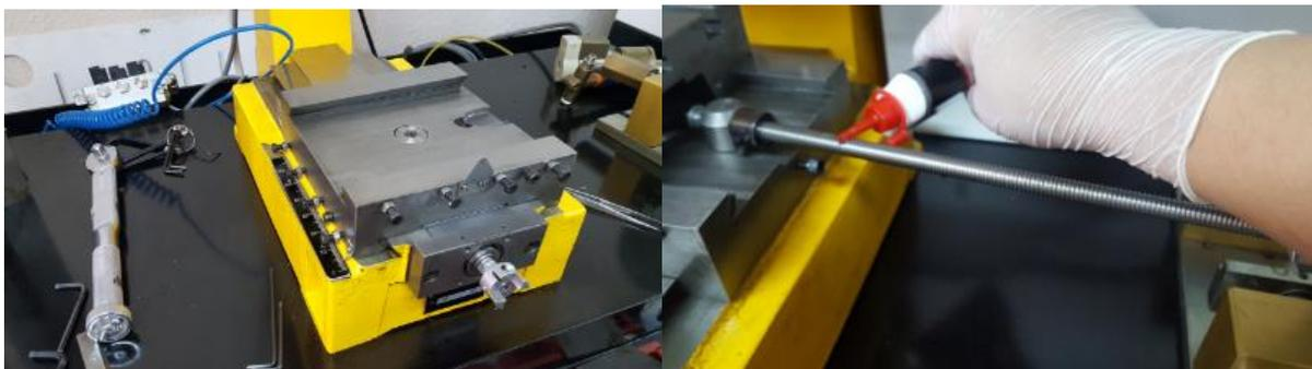
**Figura 70.** Rearmado y lubricación de la fresadora.
