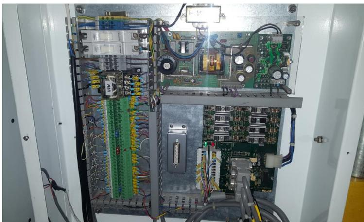
*Figura 21.* Circuitos electrónicos de la maquinada de fresado FMS 2101
