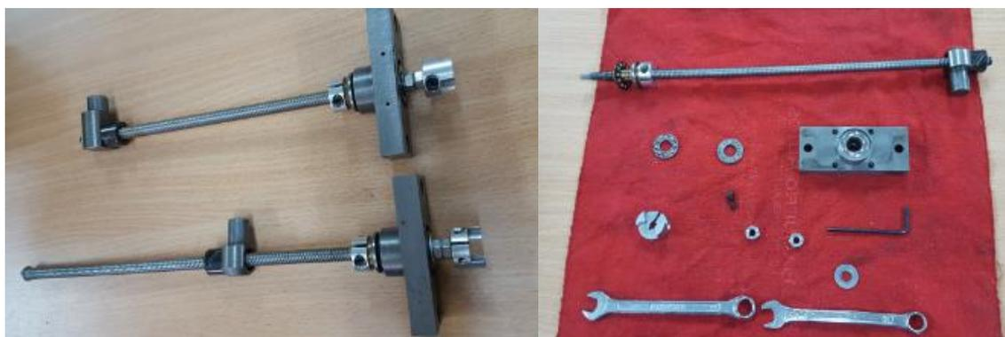
**Figura 69.** Mantenimiento de los husillos de la fresadora
