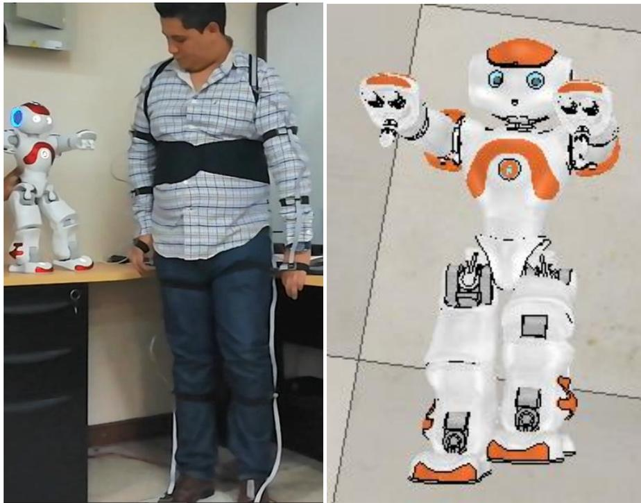
**Figura 103.** Prueba de flexión de rodilla izquierda en robot (Izq.) y simulado (Der.)
