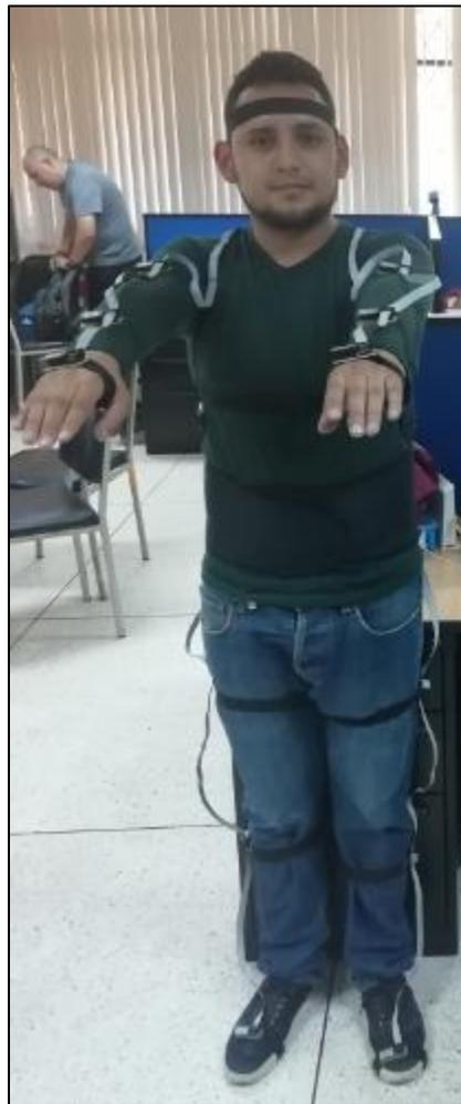
**Figura 49.** Montaje del prototipo de la red de IMU's en un humano
