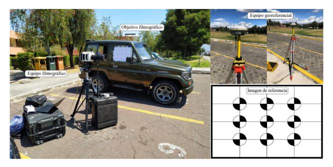
Figura 22. Equipo necesario para efectuar el ensayo de calibración
