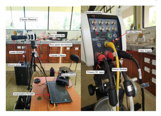
Figura 21. Equipo filmográfico de alta velocidad
