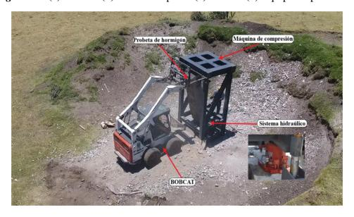
Figura 29. Montaje de la probeta de hormigón en la máquina de compresión
