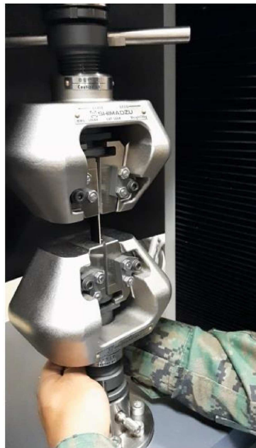
Figura 19 Ensayo de tracción en máquina de Ensayos Universales Shimadzu - 50 KN.
