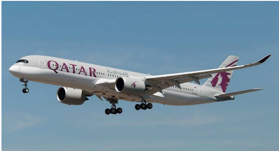
Figura 6 Aeronave Airbus A350-XWB primera aeronave con el fuselaje y estructuras del ala fabricadas principalmente de materiales compuestos.
