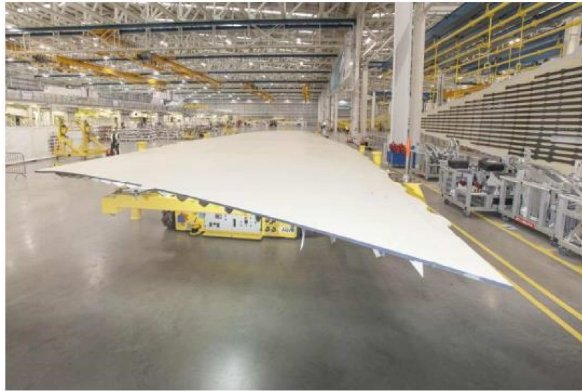
Figura 7 Primera ala de prueba para el Airbus A350-XWB. Fuente: (Noticias Aéreas, 2017)
