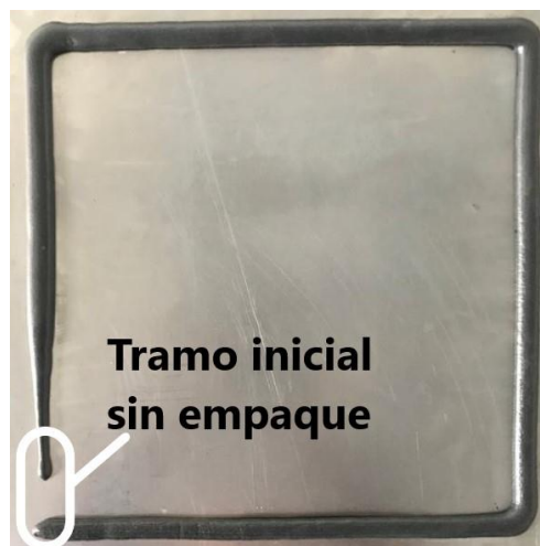
Figura 57. Tramo inicial sin empaque
