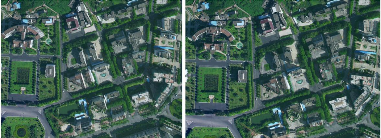
Figura 3. Fotografía Aérea sin eliminar ninguna distorsión (izquierda) y Fotografía Aérea eliminada las distorsiones (derecha) ocasionadas por el vuelo fotogramétrico Fuente: (Deng et al., 2015)
