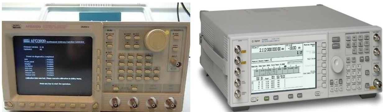
Figura 4.12. Generadores de señal adecuados para generar una señal de inhibición Fuente: (Agilent, 2019)
