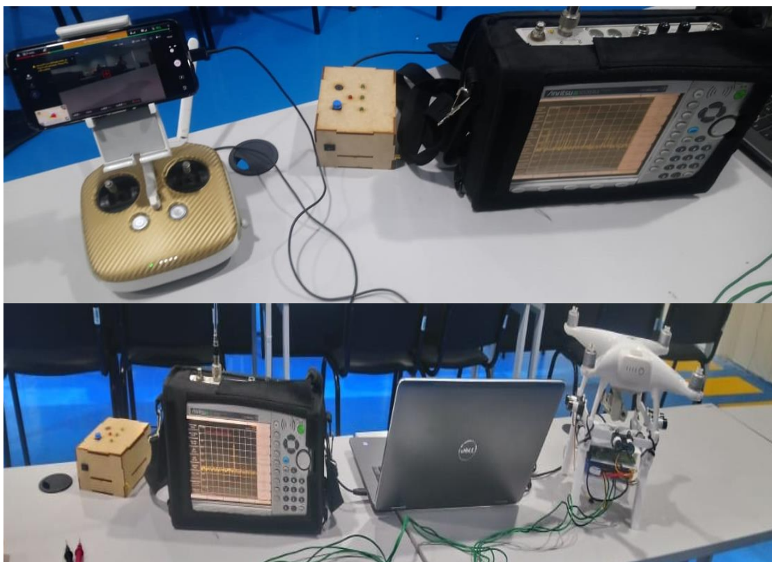
Figura 5.15. Funcionamiento del sistema: a) jammer desactivado, b) jammer activado
