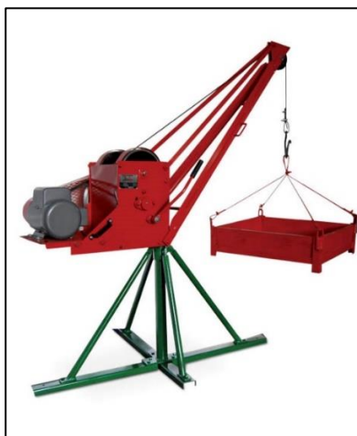
Figura 34. Equipo de Izaje de cargas
