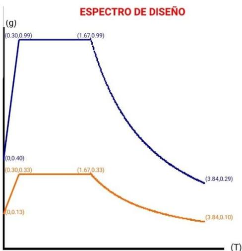
**Figura 56** Espectro de respuesta considerado para el Hospital Naval
