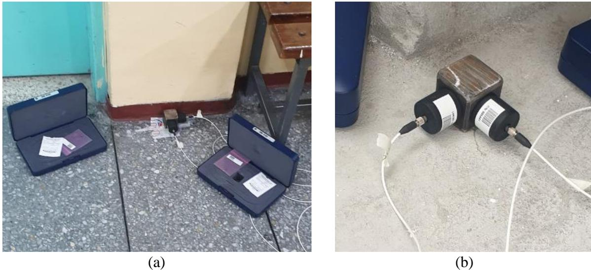
**Figura 29** Sensores uniaxiales conectados al cubo metálico para realizar el ensayo en dos direcciones.
