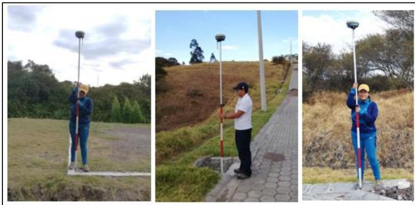
**Figura 72** Toma de puntos RTK
