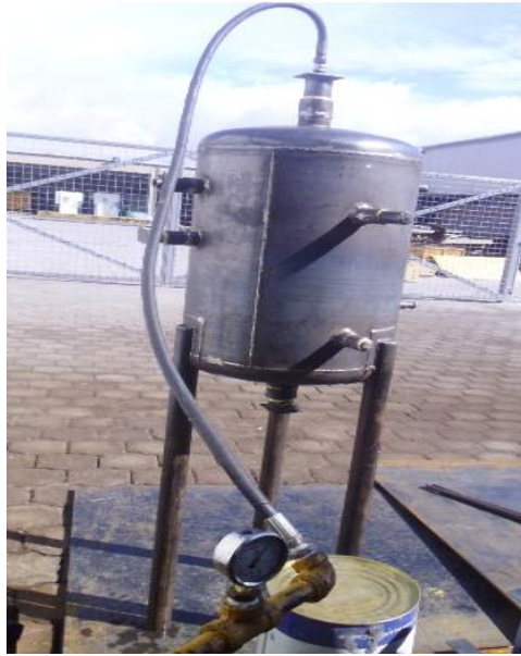
Figura 44. Tanque de almacenamiento con orificios para resistencias eléctricas
