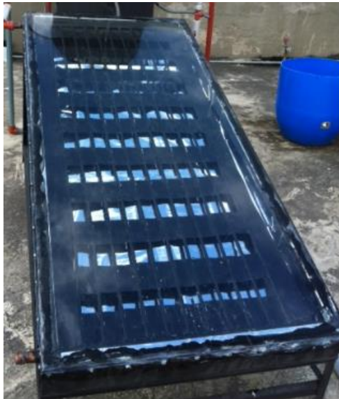
Figura 43. Caja colectora con lamina reflectora en la base
