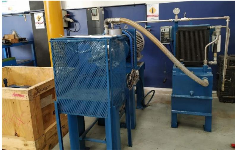
**Figura 10.** Banco de pruebas de cámaras de empuje Baker Hughes
