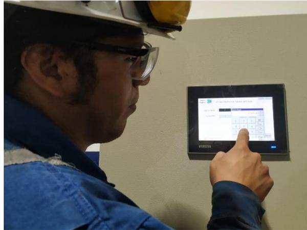
**Figura 53.** Prueba de comunicación HMI
