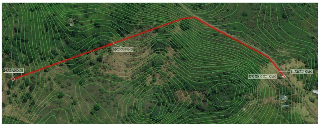
*Figura 57. Esquema del sistema de agua potable*
