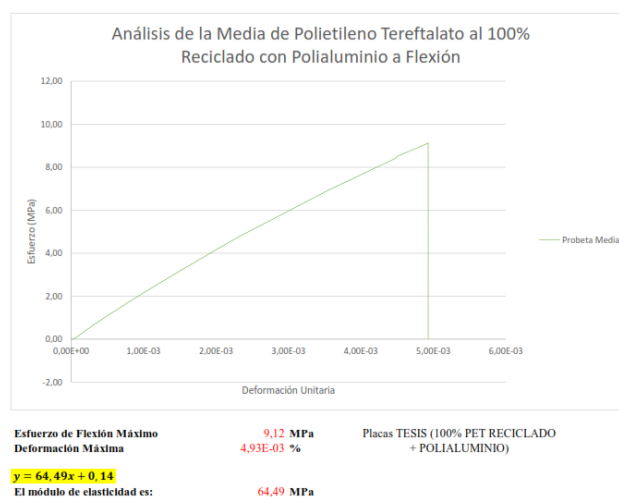
Figura 49. Resultado de la media del ensayo de flexión de las probetas con matriz 100% PET reciclado
