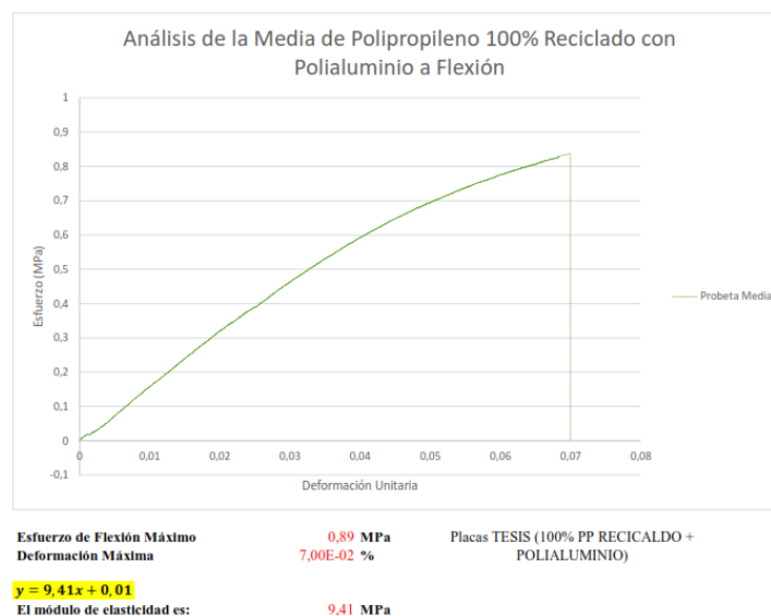
Figura 54. Resultado de la media del ensayo de flexión de las probetas con matriz 100% PP reciclado
