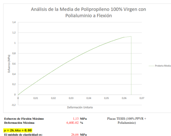
Figura 50. Resultado de la media del ensayo de flexión de las probetas con matriz 100% PP virgen
