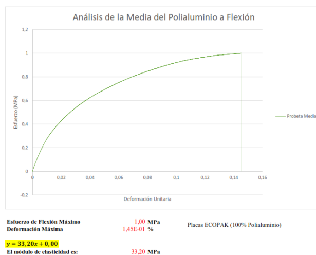
Figura 55. Resultado de la media del ensayo de flexión de las probetas del tablero Ecopak
