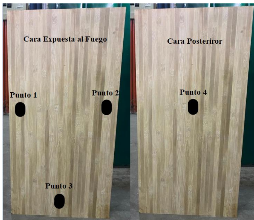
Figura 53. Puntos en donde se tomaron las temperaturas durante el ensayo
