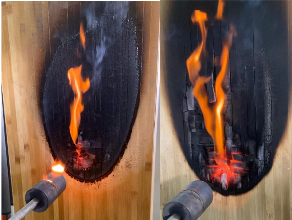
Figura 56. Presencia de llama por la combustión propia del tablero estructural en muestra PB2-FG-1 (izquierda) y PB2-FG-2 (derecha).
