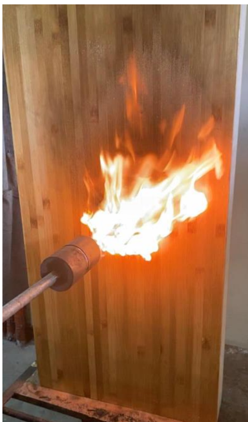
Figura 51. Ensayo de Comportamiento al Fuego
