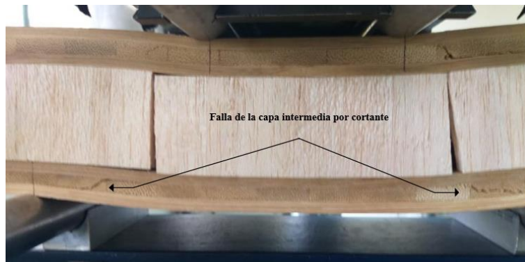
Figura 64. Falla por cortante capa intermedia de las caras
