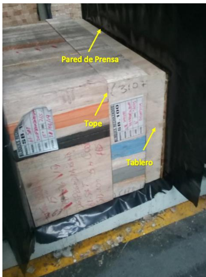
Figura 21. Prensado de Tableros
