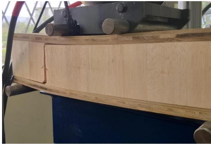
Figura 63. Falla por cortante en el núcleo
