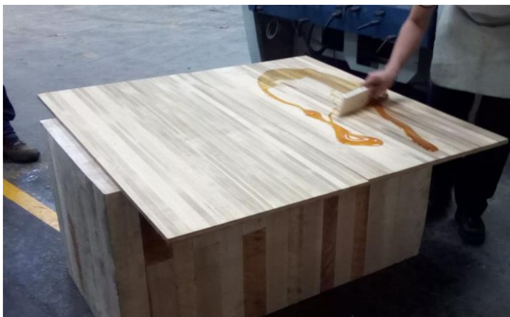
Figura 20. Distribución del poliuretano líquido en la cara superior de bambú
