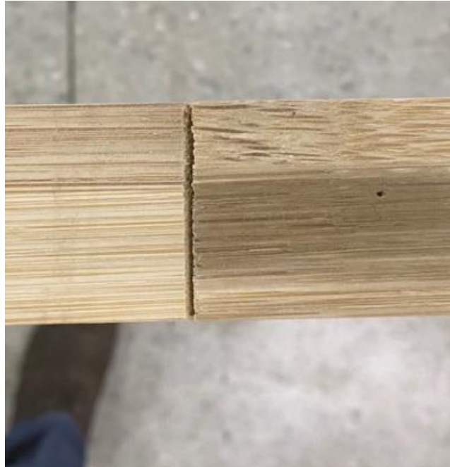
Figura 46. Falla de viga al momento de aplicar la fuerza vista superior
