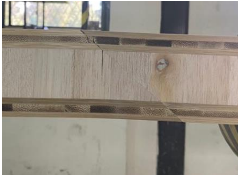
Figura 45. Falla de viga al momento de aplicar la fuerza vista lateral derecha
