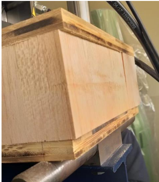
Figura 65. Deslizamiento entre el núcleo y las caras por falta de presión y adhesión
