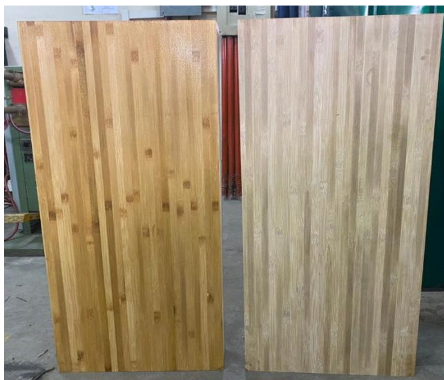
Figura 52. A la izquierda tablero con recubrimiento ignífugo y a la derecha tablero en condiciones normales.
