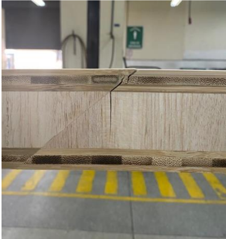
Figura 44. Falla de viga al momento de aplicar la fuerza vista lateral izquierda
