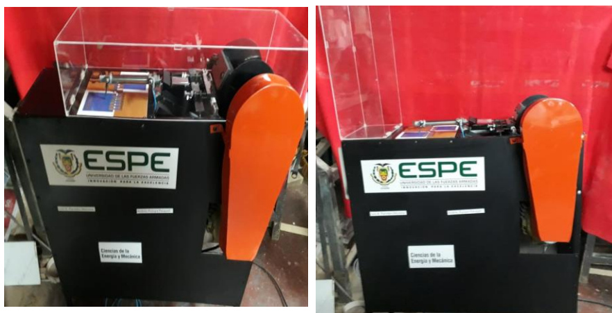
Figura 54 Banco de pruebas para medir la fuerza de corte
