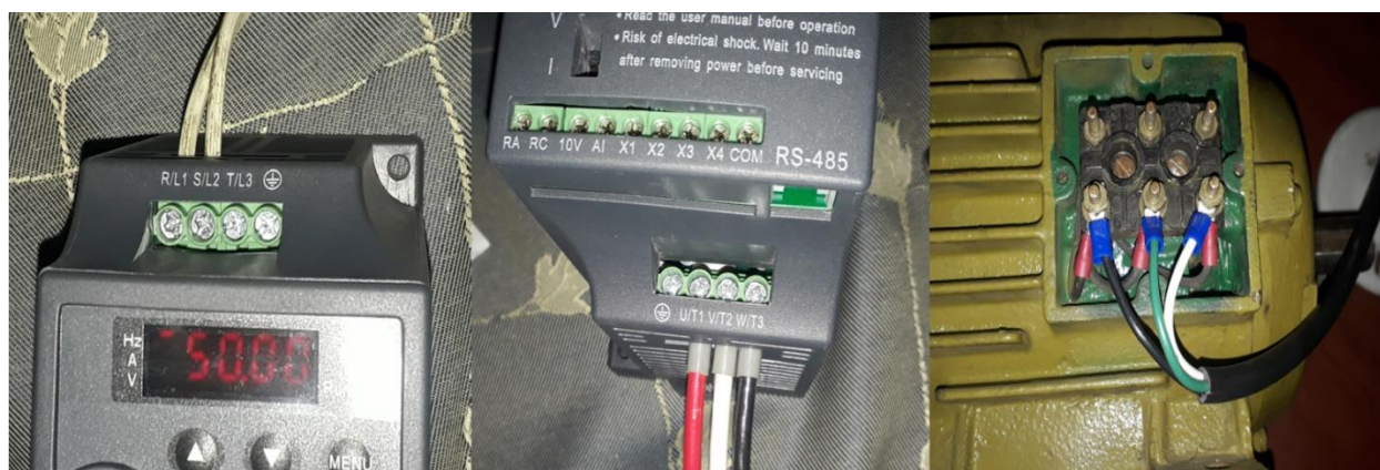
Figura 49 Conexión del variador de frecuencia al motor
