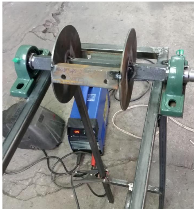
Figura 35 Montaje del eje a la estructura
