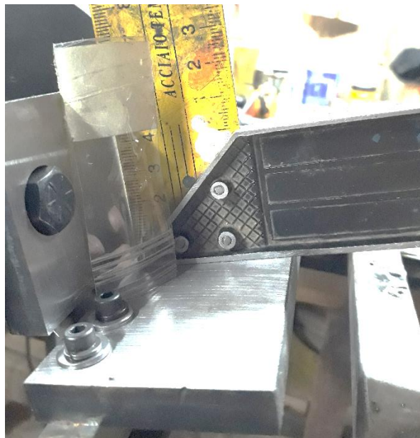
Figura 36 Disposición de las cuchillas a 90° grados
