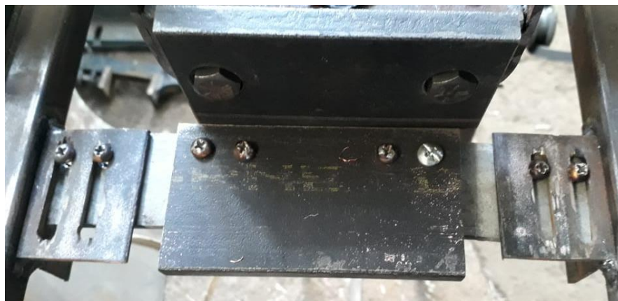
Figura 45 Mala colocación de la celda de cargas con la cuchilla fija a los apoyos
