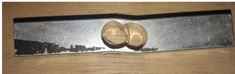
Figura 44 Celda de carga sometida a una sobrecarga
