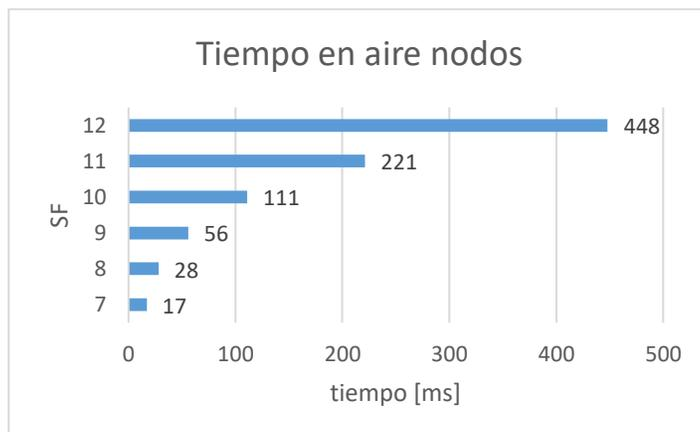
**Figura 74.** SF vs tiempo en aire prueba
