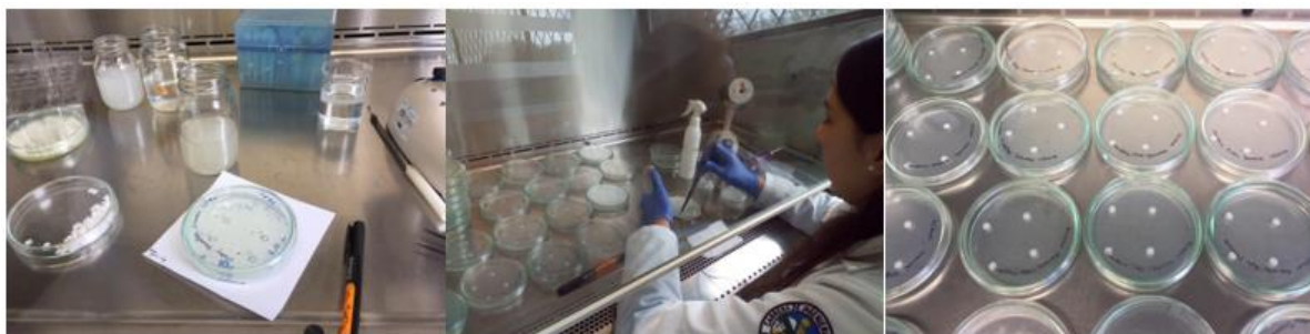
Figura 6 Metodología de sensibilidad de Beauveria bassiana a diferentes agroquímicos a) Etiquetado de cajas Petri, b) Aplicación de sensidiscos de agroquímicos y alícuota de B. bassiana , c) Incubación de muestras.
