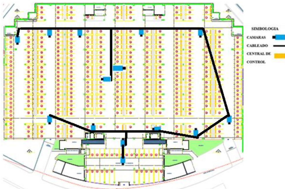
Figura 85 Ubicación de cámaras de vigilancia en el Estacionamiento Planta Baja
