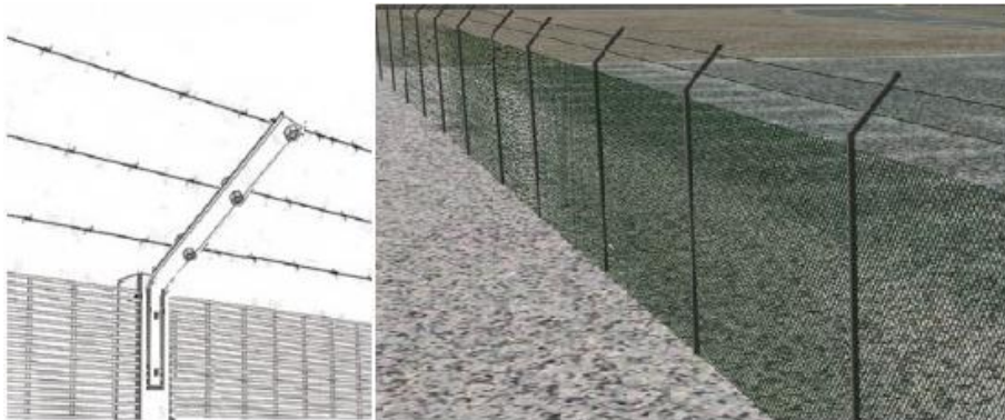
Figura 79 Instalacion de cerramiento con alambre de púas
