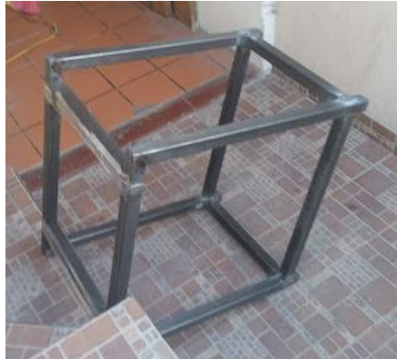
Figura 27. Armado del marco de la estructura
