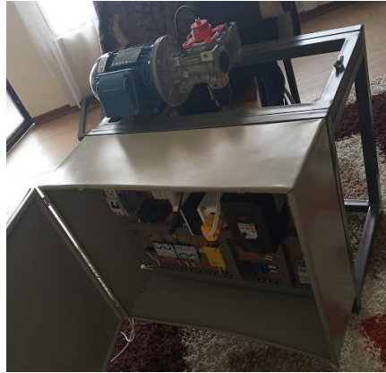
Figura 32. Montaje del gabinete a la estructura
