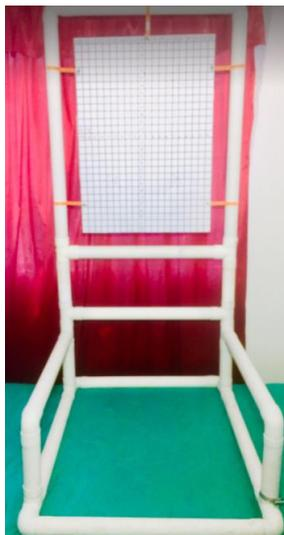
Para el diseño de todas las piezas que componen el sistema de detección y la adecuación a los tubos, se utilizó una impresora 3D, usando para ello 9 metros de tubo de desagüe de dos pulgadas, codos y T.
