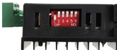
Para alcanzar una mayor precisión y un movimiento suave del rotor se debe configurar los Dip switch para 1 micro paso, el switch 1 debe permanecer en modo ON al igual que el switch 2 y el switch 3 en modo OFF, como se indica en la Tabla 23.
