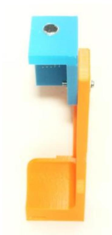
Esta estructura permite desplazarse por todo el largo del tubo para su ubicación, y variar así la altura del micrófono gracias a la estructura movable en color celeste.
