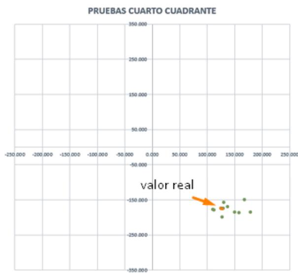
Para la segunda prueba se golpea 10 veces en la zona A y 10 veces en la zona B para determinar si impactó el objeto o no, el software Matlab nos entrega coordenadas a dichos valores se los registra en una tabla y se los compara con la coordenada real y se determina si impacto o no en la zona
