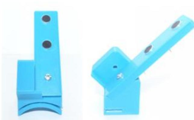
La estructura de los micrófonos laterales permite variar su inclinación, pero no la posición de los micrófonos ya que es un requerimiento que estas se encuentren a 30mm de separación.
