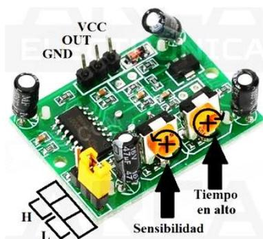
*Nota. La grafica indica el Modulo Pir motion detector HC-SR501, Tomado de (Arca Electrónica, 2019)*
