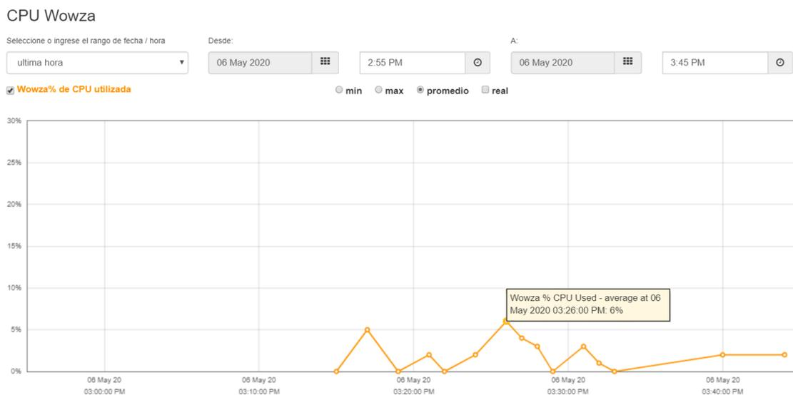
Durante el período de prueba, en la *Figura 72* se pudo observar un pico que alcanzó el 6%, esto sucedió en el instante en que el dispositivo estableció la conexión con el servidor, posterior a esto, la conexión se la mantuvo y la cantidad de recursos que utilizó el servidor para transmitir contenidos bajó considerablemente y no superó el 3% de recursos del CPU.
