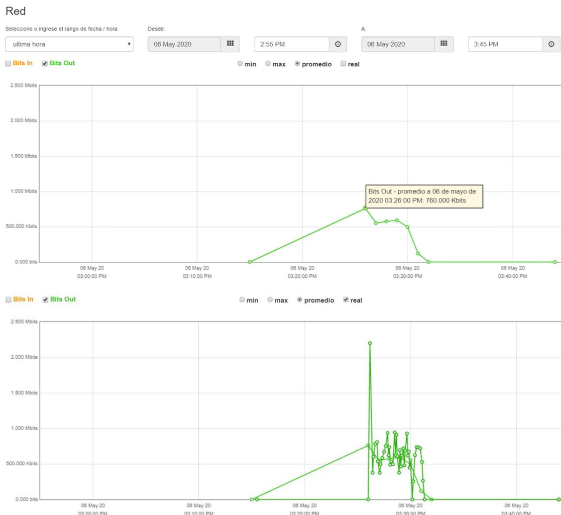
En el instante en que el usuario accede al servidor se empieza a transferir datos en cada momento, siempre y cuando la conexión se la mantenga, en la *Figura 71* se puede evidenciar una cantidad mayor de bits apenas empieza la transmisión con un valor promedio de 760 kbps, mientras que, al desplegar el gráfico real, el pico inicial alcanzó los 2,3 Mbps aproximadamente y después de establecerse la conexión se observa una variación constante de bits que va en aumento pero no supera el 1 Mbps.
