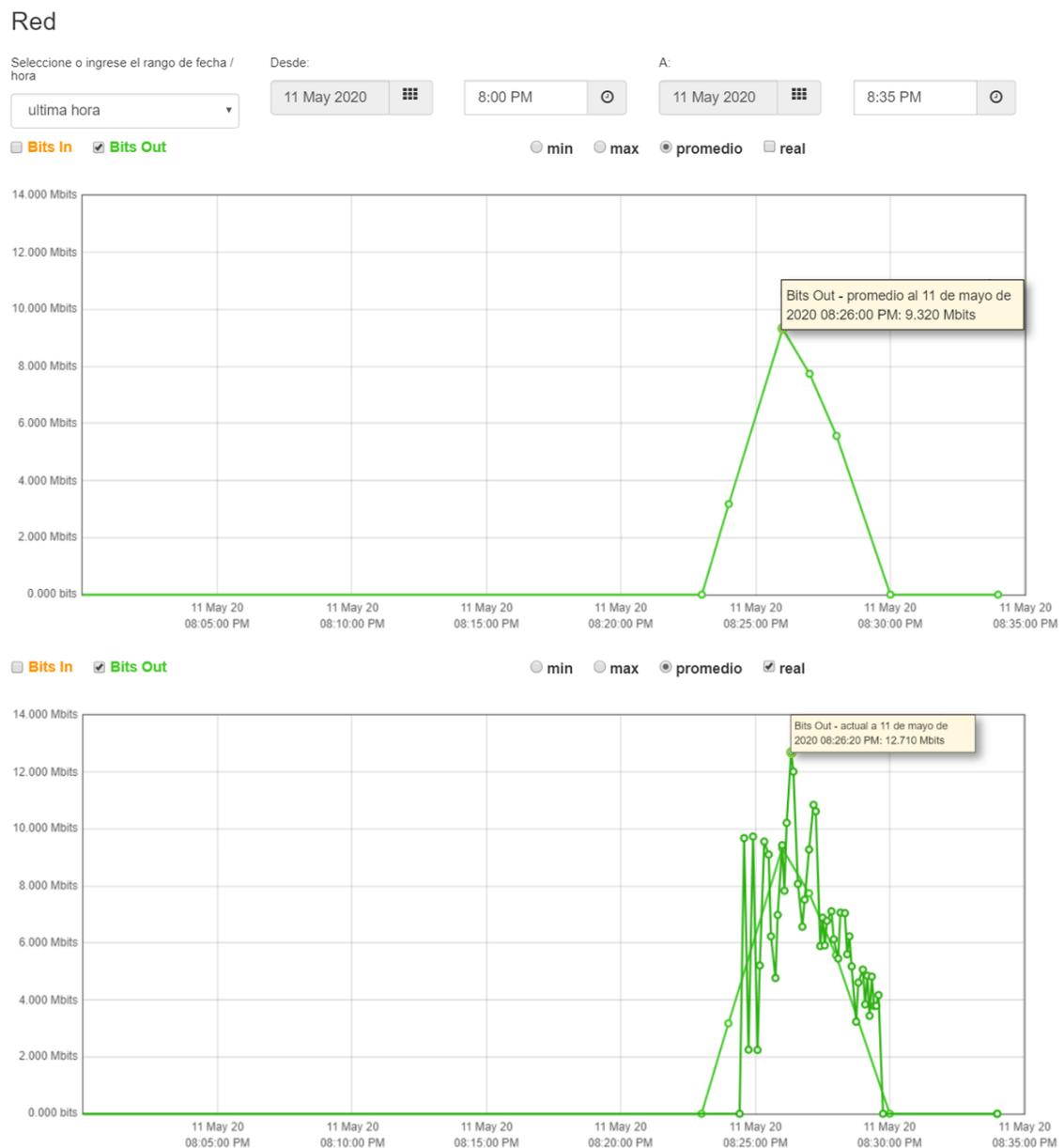
Mientras tanto, al activar el gráfico real se observa un pico en cada instante en que los dispositivos establecen la conexión, evidenciando un mayor tráfico soportado en el momento en que el último usuario establece la conexión alcanzando los 12,71 Mbps.
