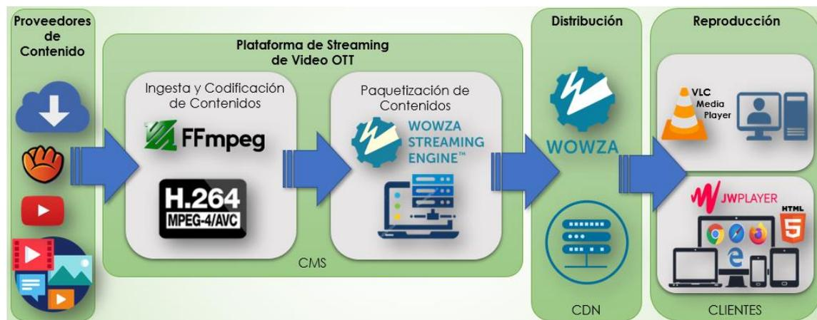
Al ser implementada una plataforma OTT a menor escala, en la etapa de ingesta y codificación de contenidos, se reemplaza los codificadores físicos y robustos, por el software FFMPEG, el cual se encargará de codificar y comprimir los videos en distintas
