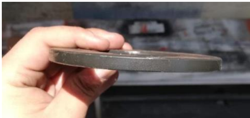
Torsión de la Geometría de los Discos del Acople
