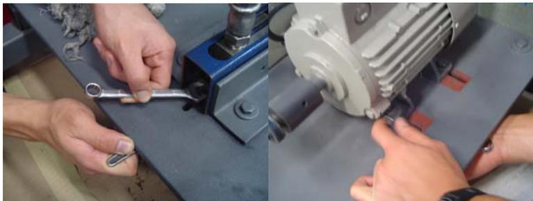
**Figura 5.14 Ajuste de elementos según probeta a emplearse**
