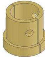
**Figura 4.42 Esquema del buje de sujeción para tubería de 3/4"**
