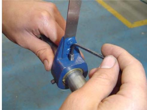
**Figura 5.27 Ajuste de prisioneros en tubería para ensayo 3**
