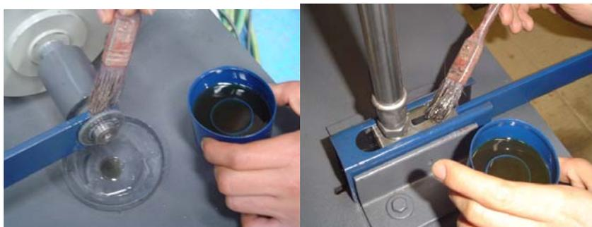
**Figura 5.15 Lubricación de elementos**
