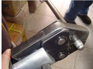
**Figura 5.35 Prensado del tapón de la probeta para ensayo 3**
