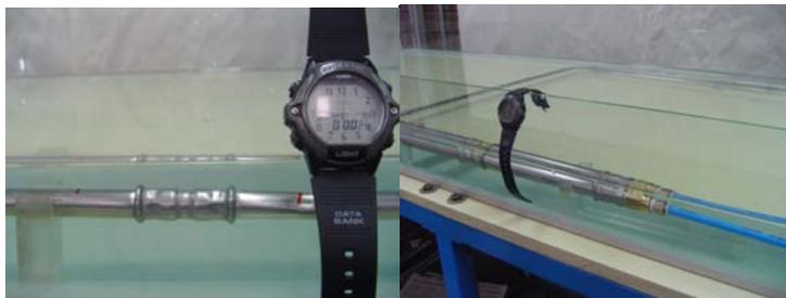
**Figura 5.37 Ensayo de impermeabilidad de probeta de ensayo 3**
