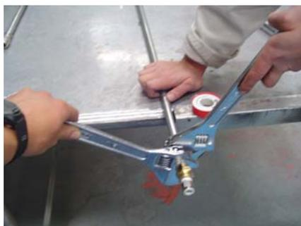
**Figura 5.6 Colocación de acople en accesorio roscado de probeta para ensayo 1**
