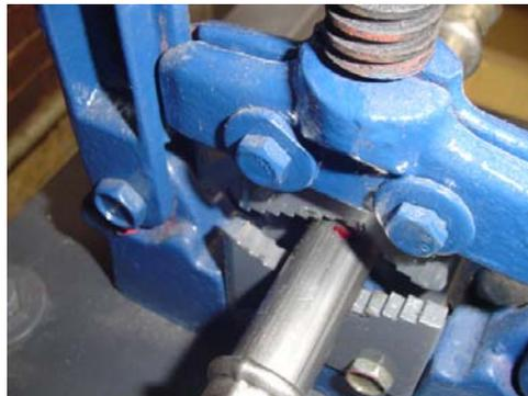
**Figura 5.28 Disposición de probeta en entenalla para ensayo 3**
