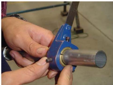
**Figura 5.26 Disposición del accesorio transmisor de torque en tubería para ensayo 3**
