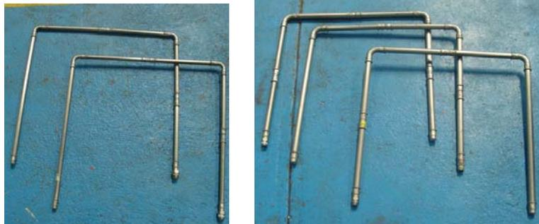
**Figura 5.39** Probetas sometidas a ensayos de resistencia a flexión por vibración.
