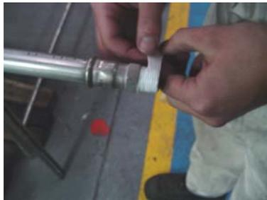
**Figura 5.36 Colocación de teflón en accesorio roscado de probeta para ensayo 3**
