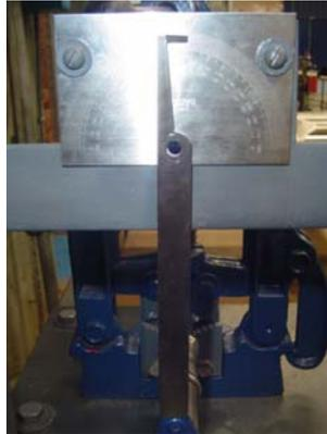
**Figura 5.32** Desmontaje del perno posicionador para ensayo 3
