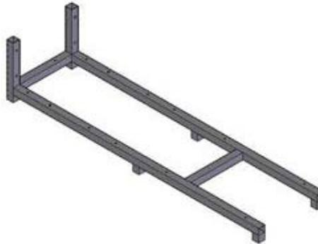
Figura 4.11 Esquema de la estructura para ensayo de resistencia a flexión por vibración
