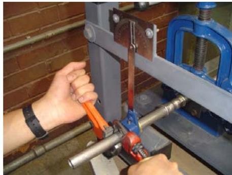
**Figura 5.33** Disposición de las llaves de tubo para ensayo 3
