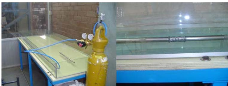
**Figura 5.7 Ensayo preliminar de impermeabilidad de probetas de ensayo 1**
