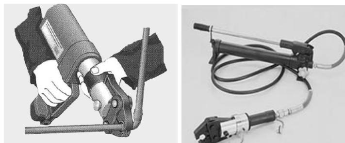
**Figura 2.5 Bombas hidráulicas**
