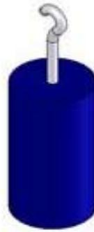
Figura 4.7 Esquema del peso para probeta de diámetro de 1/2"
