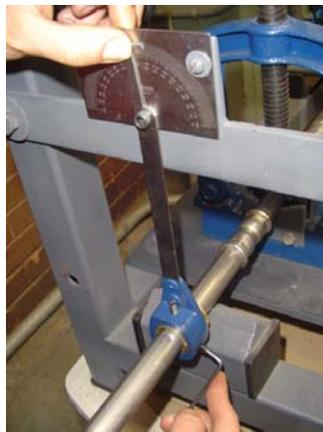
**Figura 5.31 Ajuste de los prisioneros en para ensayo 3**
