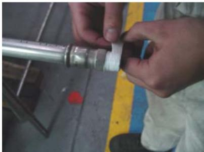
**Figura 5.5 Colocación de teflón en accesorio roscado de probeta para ensayo 1**
