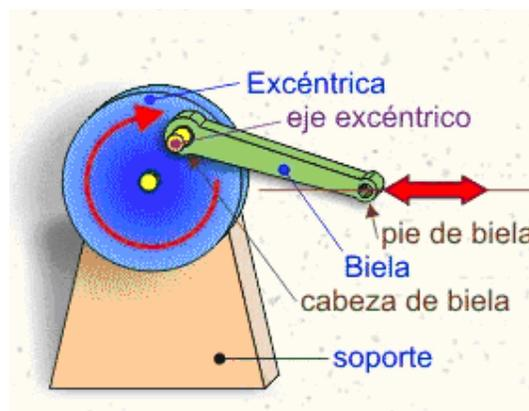
**Figura 3.9 Esquema del mecanismo biela manivela con eje excéntrico**
