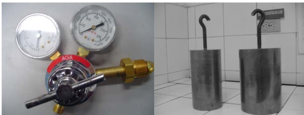
**Figura 5.1 Manómetros y pesos a ser calibrados en el INEN**
