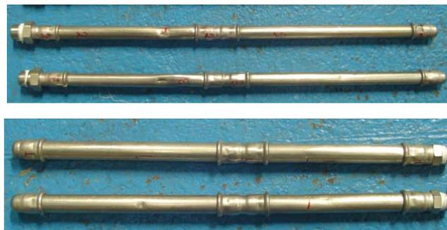
**Figura 5.40** Probetas sometidas a ensayos de resistencia a esfuerzo a torsión.
