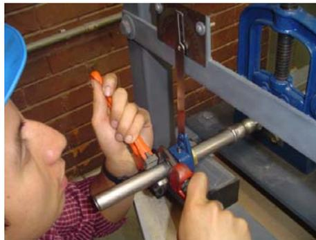
**Figura 5.34** Aplicación de par necesario
