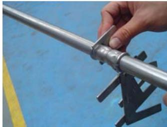
Figura 5.3 Verificación de junta con pasa/no pasa de probeta ensayo 1
