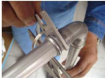
Figura 5.11 Verificación de junta con pasa/no pasa de probeta ensayo 2
