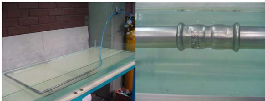
Figura 5.12 Ensayo preliminar de impermeabilidad de probetas de ensayo 2
