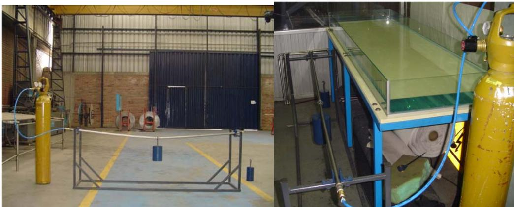
**Figura 5.9 Disposición final de ensayo de resistencia estática a flexión**
