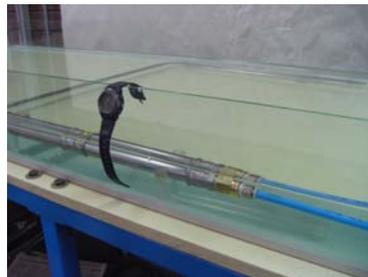
**Figura 5.20 Ensayo de impermeabilidad de probeta de ensayo 2**
