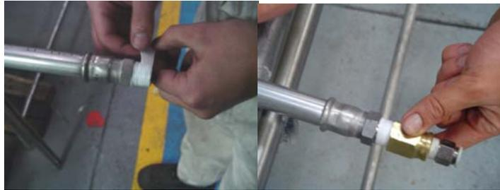
**Figura 5.19 Colocación de teflón y acople en accesorio roscado de probeta para ensayo 2**
