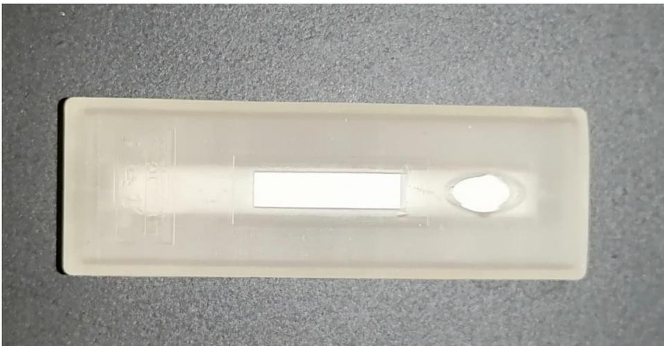
*Nota.* La cubierta fue impresa por estereolitografía. Diseño en el software Rhinoceros 5.0
