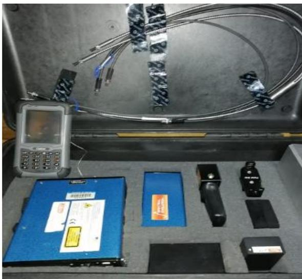
*Nota.* La figura muestra el espectroradiómetro con todos sus accesorios para el levantamiento de la información espectral.
