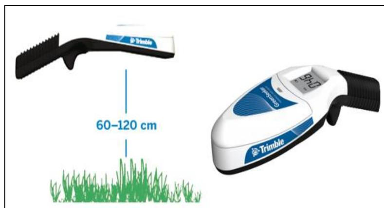
*Nota.* La figura muestra la forma adecuada para la obtención de valores NDVI con el sensor de cultivos GreenSeeker. Tomado de: (Trimble, 2016).
