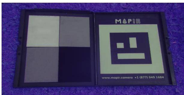
*Nota.* La imagen muestra la tarjeta de calibración necesaria para realizar la corrección radiométrica.
