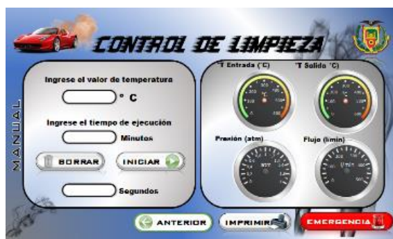
Figura 32. Pantalla de Panel - Control Manual
