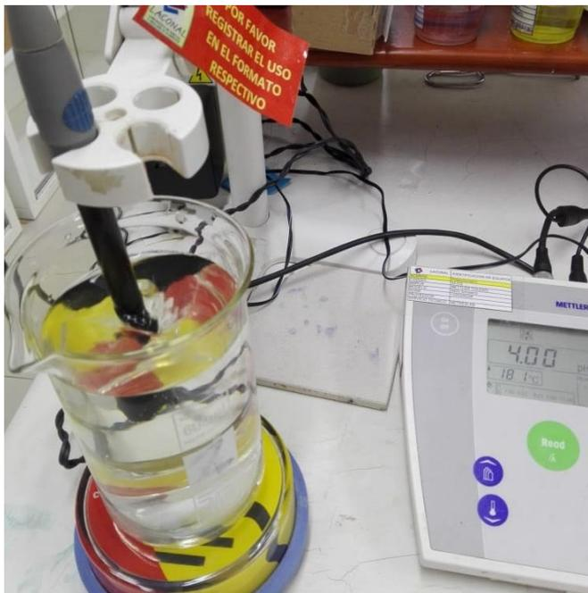
**Figura 9.** Medición de pH de muestras según la norma INEN
