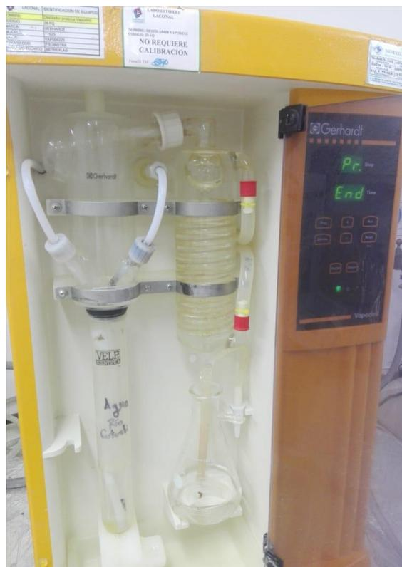
**Figura 10.** Unidad de destilación, marca Gerhardt y modelo TT625.
