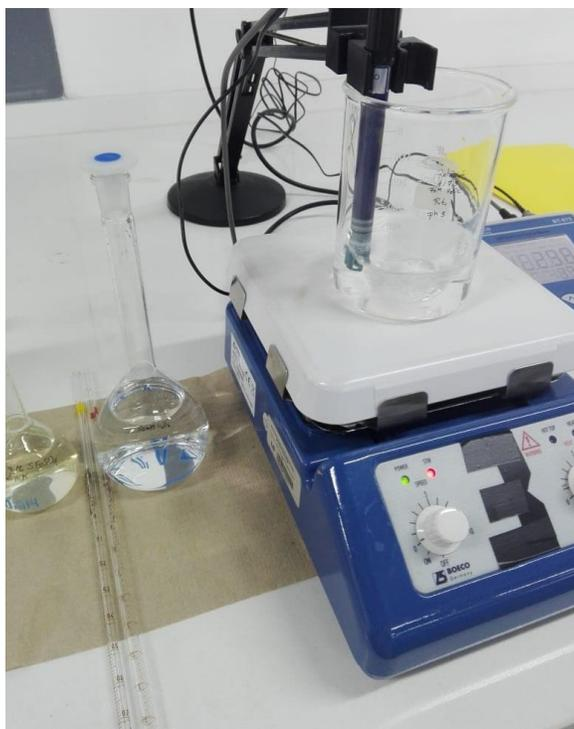
**Figura 21.** Reacción de oxidación avanzada en reactor Batch
