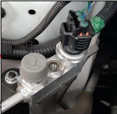
Sensor temperatura Evaporador
