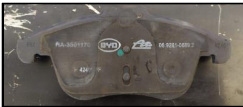
Figura 11. Pastilla de freno vehículo BYD E5 300, con sus características
