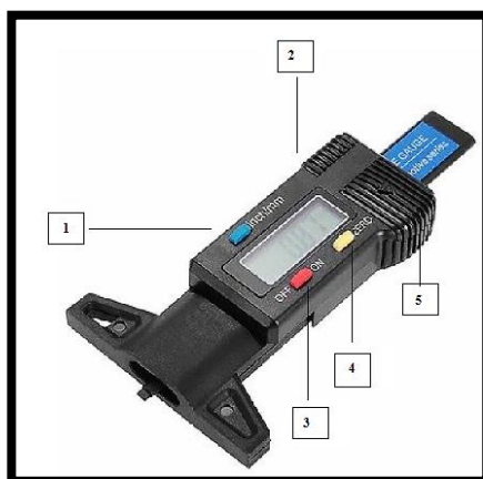
Figura 49. Partes del medidor de profundidad Fuente: (Mitutoyo, 2011)
