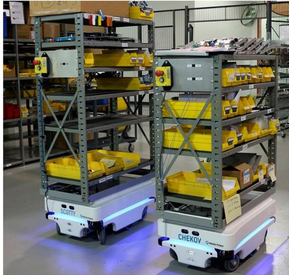
**Figura 13.** Robot industrial móvil
