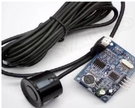
**Figura 38.** Sensor Ultrasónico sumergible
