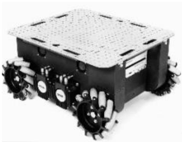
**Figura 6.** Locomoción omnidireccional
