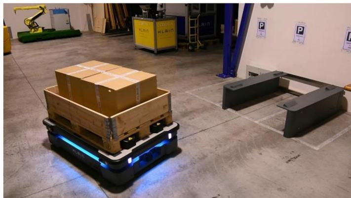
**Figura 12.** Robot móvil autónomo.
