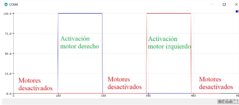
**Figura 117.** Curvas de verificación de activación de los micro-motores de sistema háptico.
