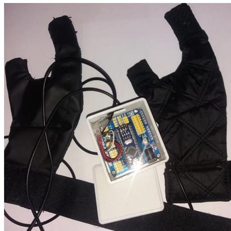
**Figura 40.** Ensamble Total de Dispositivo Háptico.
