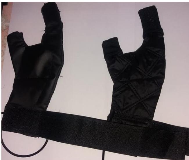
*Figura 37.* Diseño final del par de guantes para el Sistema Háptico.
