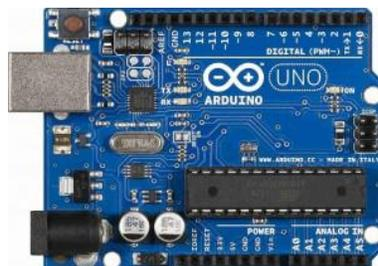
**Figura 19.** Tarjeta de control Arduino Uno.
