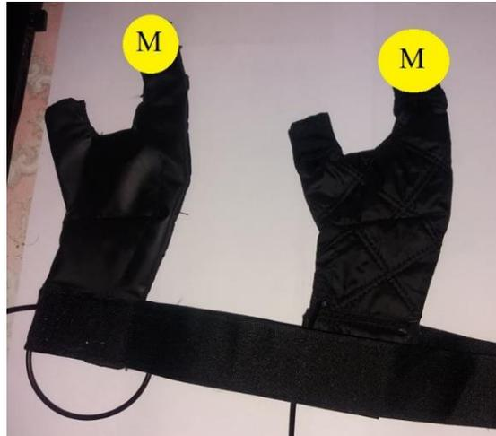
**Figura 39.** Disposición de los micro-motores de vibración en el guante.
