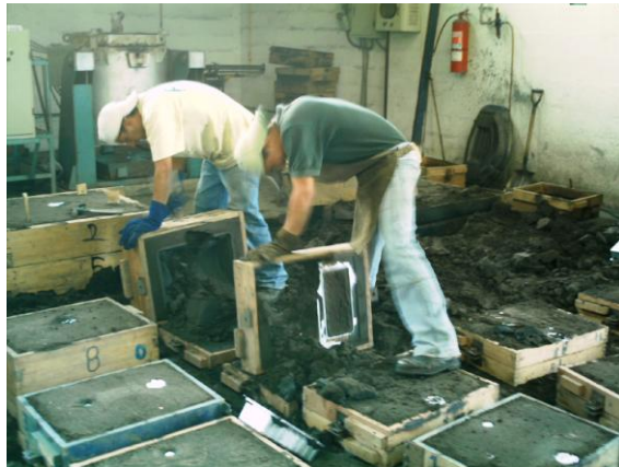
Foto Z37.- Desmoldeo
