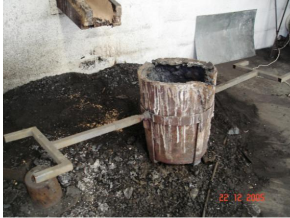
Foto E20.- Equipo de colado (crisol-cayana)
