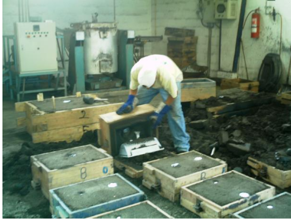
Foto Z38.- Desmoldeo
