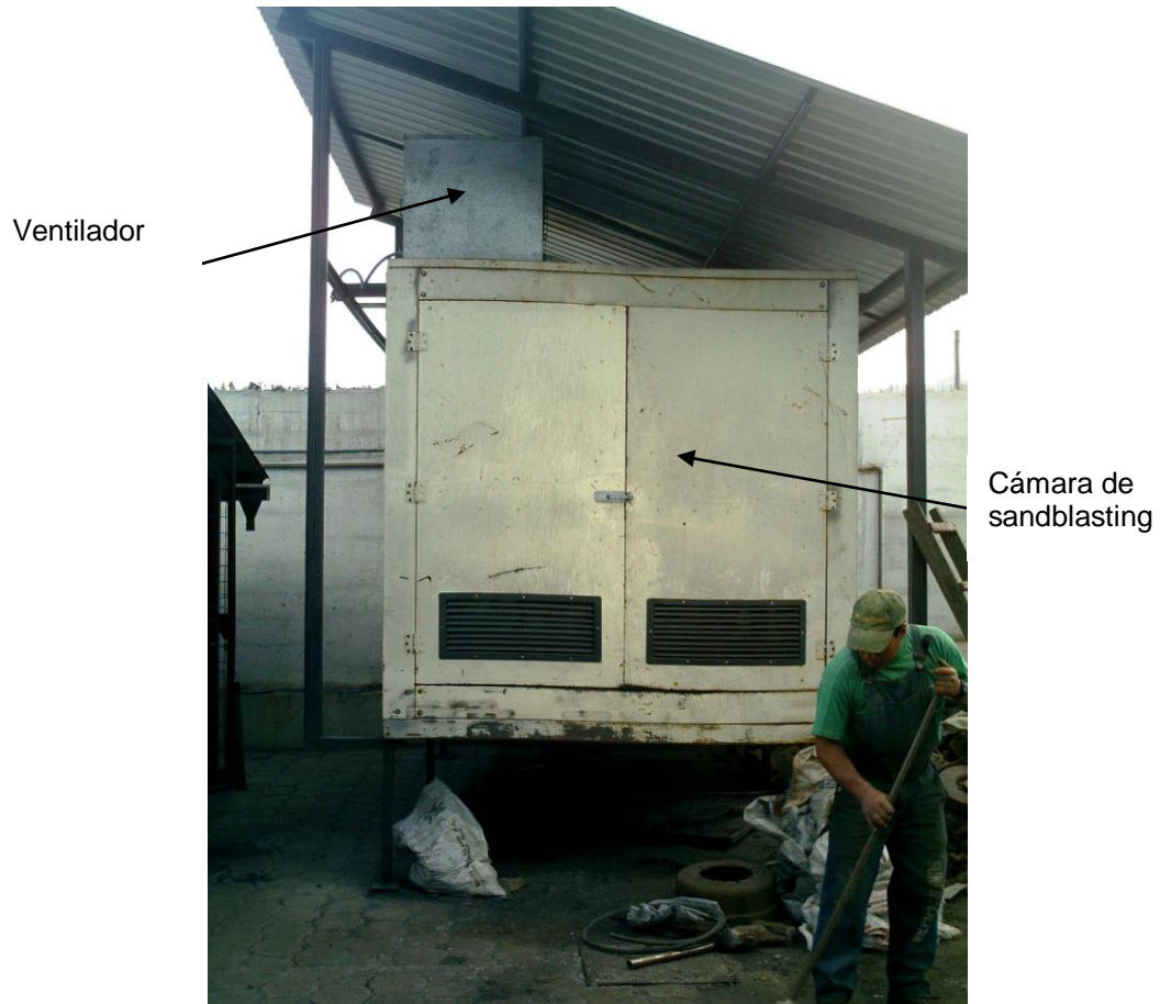
Foto E23.- Equipo de sandblasting
