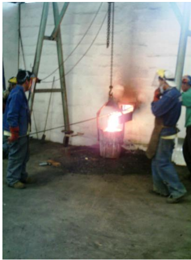
Foto Z30.- Recepción de la colada de hierro gris
