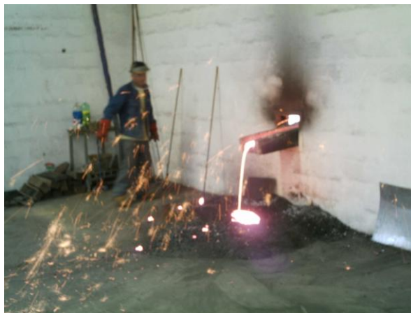
Foto Z28.- Apertura del canal de colado
