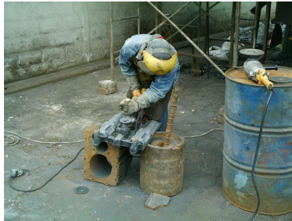
Foto Z41.- Eliminación del sistema de alimentación y desfogue
