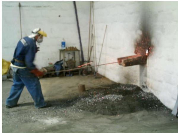
Foto Z27.- Apertura del canal de colado
