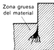
Figura Y4.- Grietas en la estructura de la fundición
