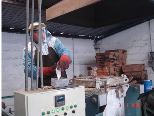
Foto Z26.- Carga del horno a gas con cloruro de sodio
