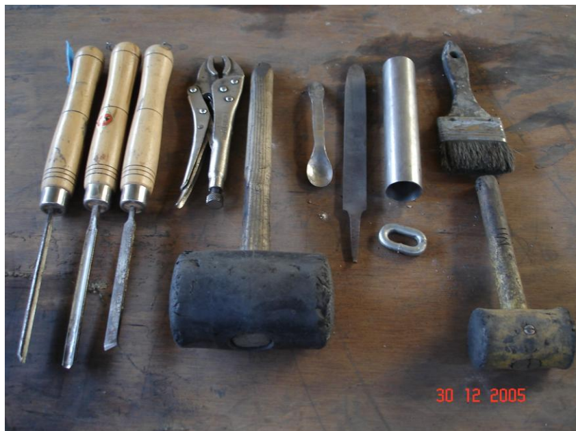
Foto G7.- Cinceles, gubias, alicate, martillo de goma, combo largo, espátula, lima, tubos para el sistema de alimentación, brocha, martillo.
