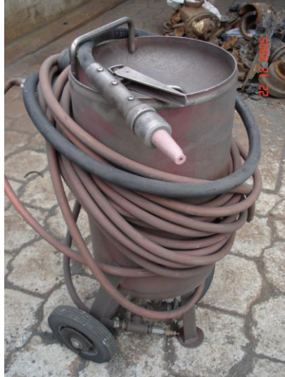
Foto E24.- Equipo de sandblasting (depósito de arena)
