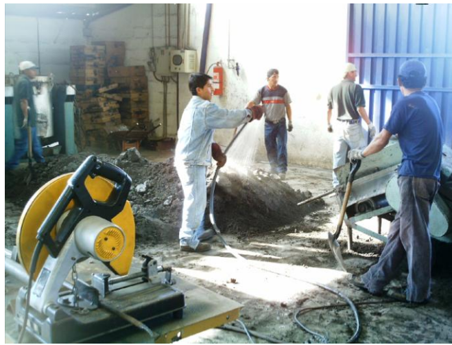
Foto Z6.- Mojado de la arena
