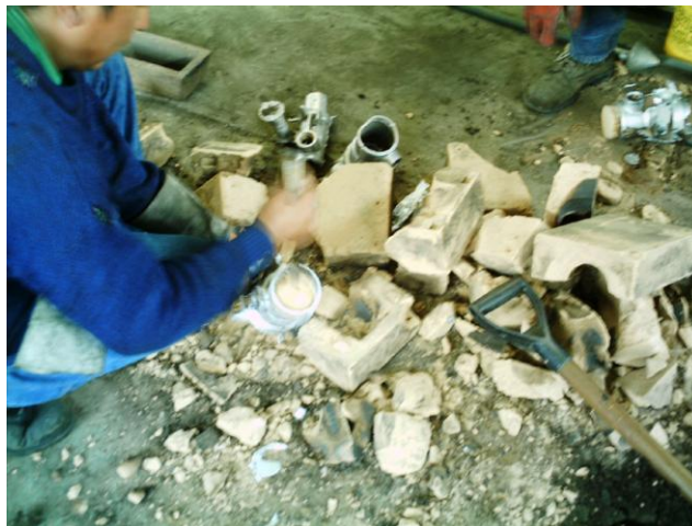
Foto Z39.- Rotura de machos
