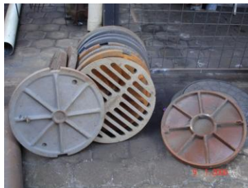
Foto B6.- Tapas y rejillas de alcantarilla.
