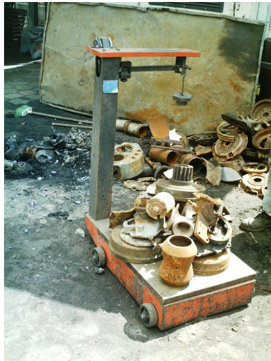
Foto Z4.- Preparación de la carga metálica
