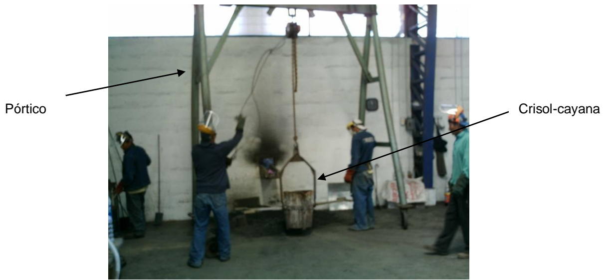
Foto E21.- Equipo de colado
