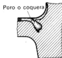
Figura Y2.- Poros donde aumenta el espesor
