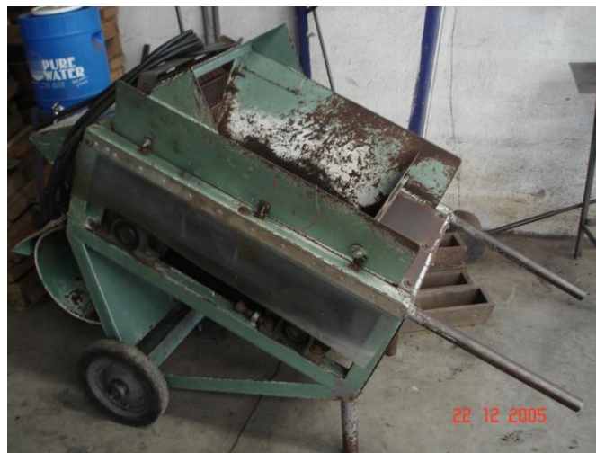
Foto E14.- Equipo de regeneración de arena
