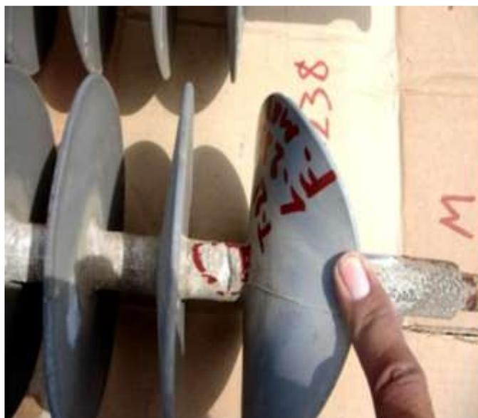
**Figura 17.** Aislador polimérico trizado pero con resistencia la flameo.
