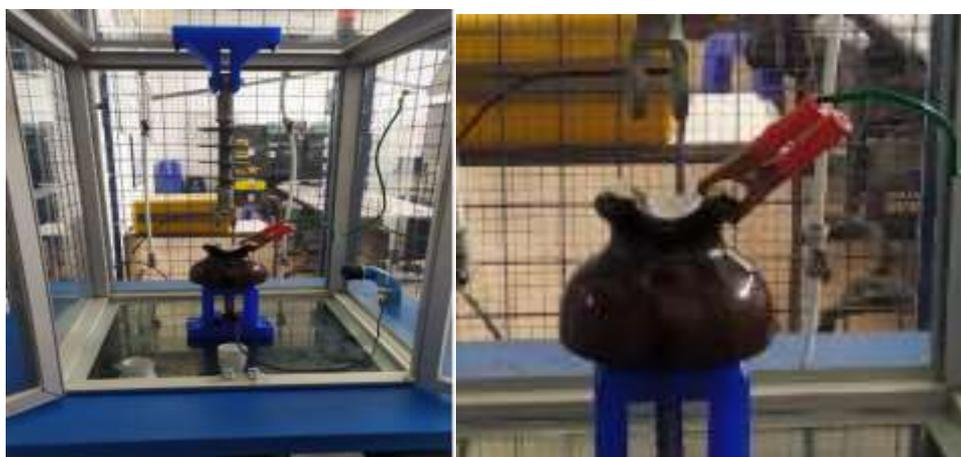
**Figura 52.** Aislador cerámico Tipo Pin Sencillo GAMMA CORONA ANSI-4, NBA 95Kv, 13 Kn ubicado para pruebas de simulación climática.
