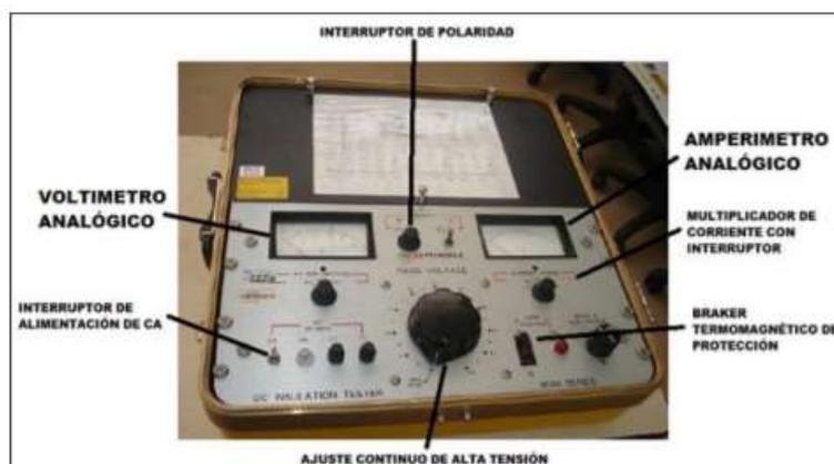
**Figura 23.** Tablero de control de HI-120Kv.
