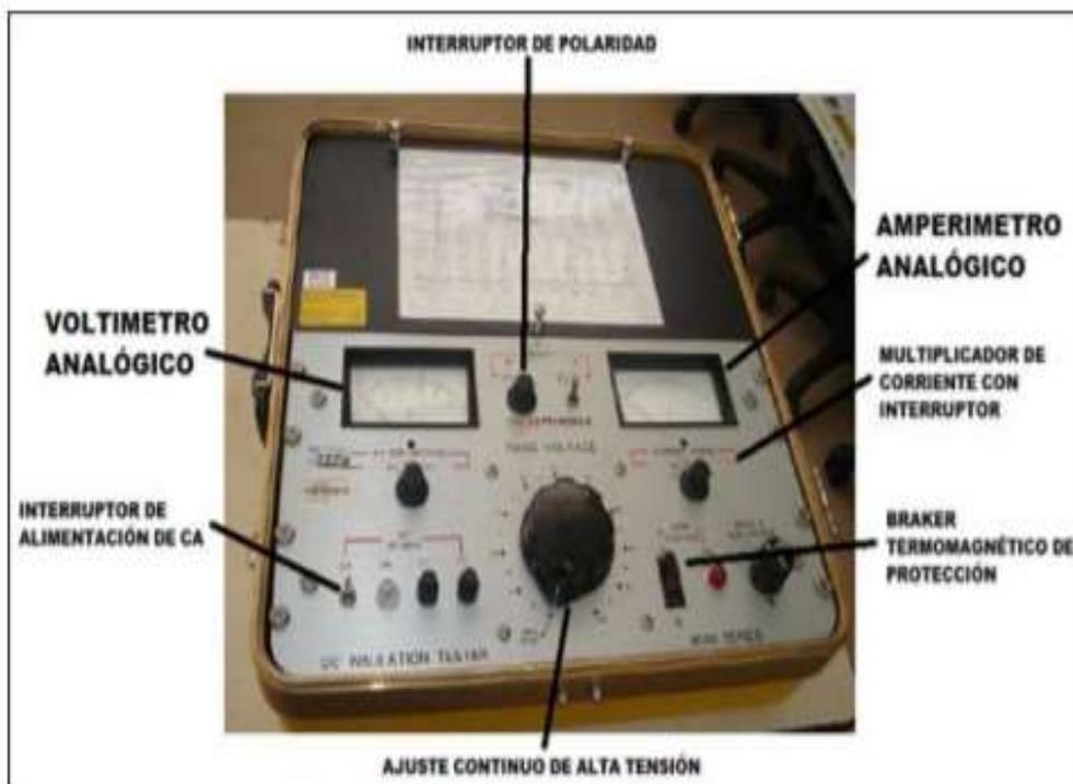
**Figura 48.** Tablero de control de HI-POT 120Kv.
