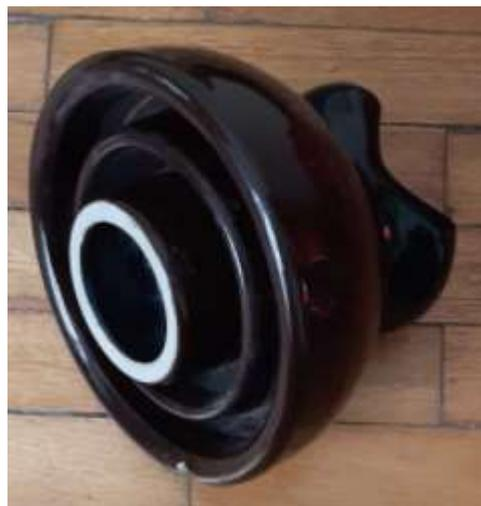
**Figura 31.** Aislador tipo PIN de Porcelana ANSI 55-4.
