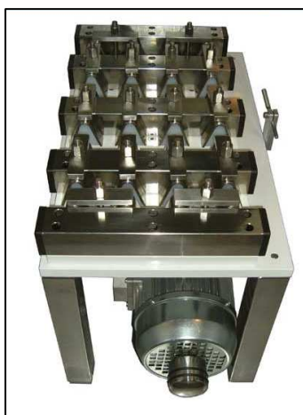
Figura 16. Flexómetro para resistencia a la flexión de polímeros
