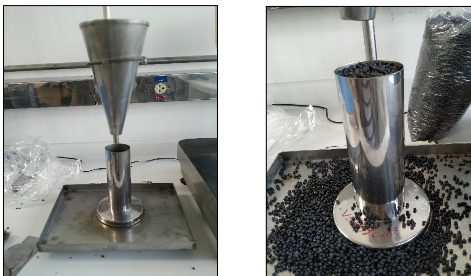
Figura 23. Equipo utilizado para ensayo de Densidad Aparente
