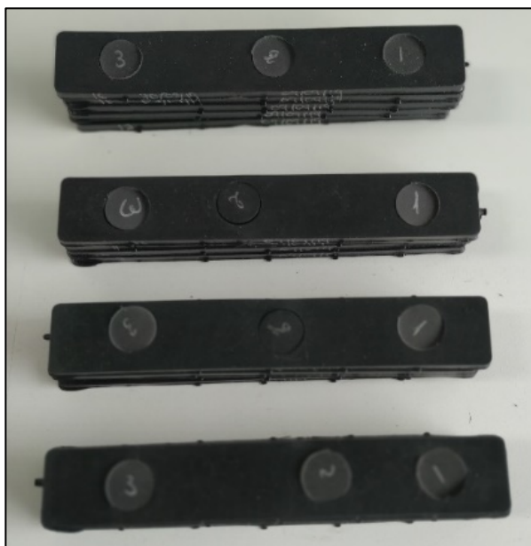
Figura 18. Probetas inyectadas y troqueladas para realizar el ensayo de abrasión
