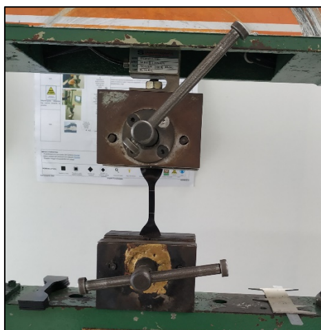
Figura 21. Ubicación de la probeta en la máquina para ensayo de tensión
