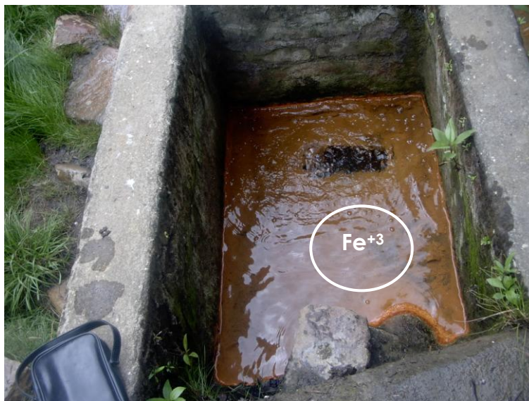
Fotografía 5.4: Depósitos de Fe en la fuente geotermal La Merced de Nono Autoras 2007
