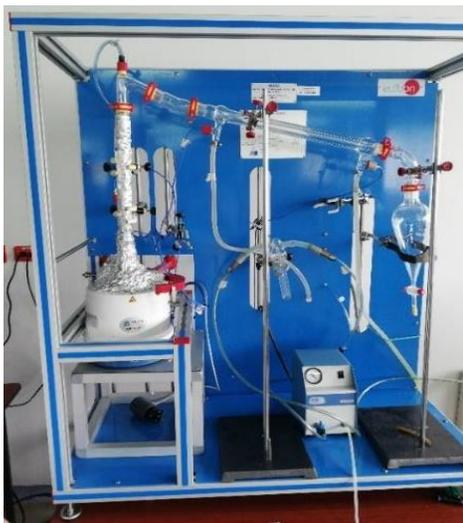
Una vez que se armó el equipo, se encendió el software que lo controla. A continuación, se accionó el sistema de refrigeración y se puso en funcionamiento la bomba de vacío, verificando que la presión fue de 0,56 bar en el inicio de la operación. Además, se encendió el sistema de extracción de vapores del laboratorio.
