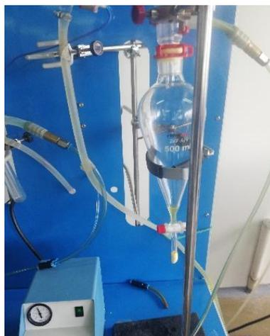
Una vez finalizado el proceso, se estableció que el tiempo de reacción fue de 360 minutos (6 horas) y se apagó la bomba de vacío seguida de la manta de calefacción con el fin de que el residuo de los vapores se condense y pueda recuperarse como producto líquido.
