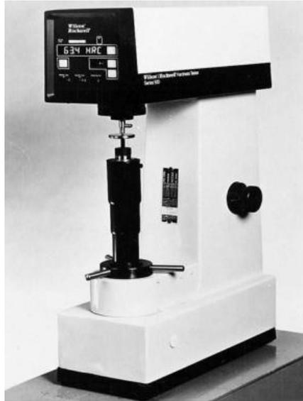
*Nota. La Figura muestra la máquina utilizada para ensayos de dureza. Tomado de Ciencia de Materiales Aplicaciones en Ingeniería (p.134), por Newell, J. 2009, Alfaomega.*
