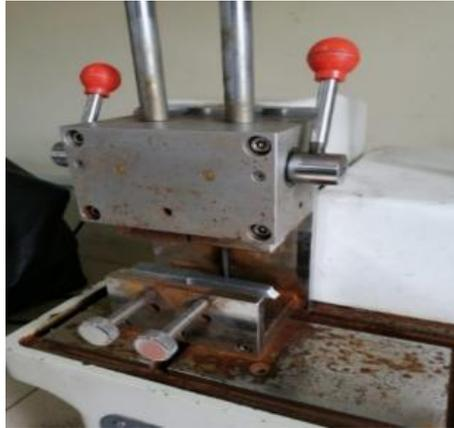
*Nota.* La imagen muestra la máquina donde se realizó el corte de la muestra para el análisis metalográfico.
