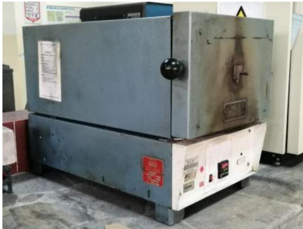
*Nota.* La figura muestra el horno utilizado para el tratamiento térmico de normalizado.
