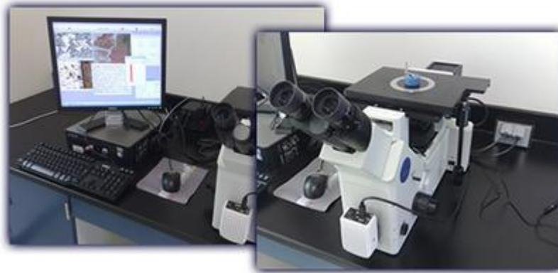
*Nota.* El gráfico representa un microscopio óptico OLYMPUS GX-51. Tomado de <http://mty.cimav.edu.mx/metalografia/>, por Esneider, M. en 2012, *MICROSCOPIO ÓPTICO [ILUSTRACIÓN]*. Cimav.
