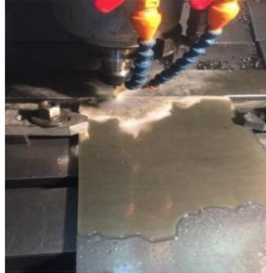
*Nota.* La imagen representa el corte y lubricación de la pieza de aluminio.
