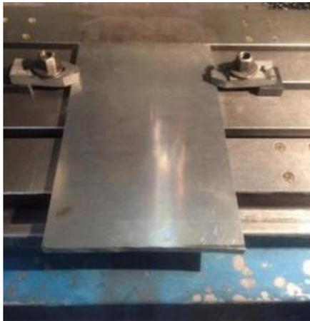
*Nota.* La figura representa la fijación de la placa del aluminio para el proceso de corte.
