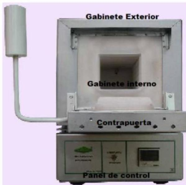
*Nota.* El gráfico representa las partes del horno de mufla. Tomado de *Diseño y construcción de un horno mufla para la realización de tratamientos Ingeniería en aceros* (p.2), por Monteros, L. 2015.
