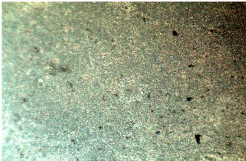
*Nota.* En la imagen se muestra una fotografía de la muestra con tratamiento térmico de normalizado a 300°C vista con el microscopio con un aumento de 500X.
