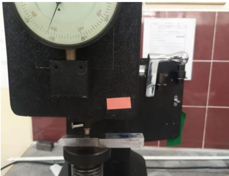
*Nota.* En la imagen se muestra como se realizó la toma de datos de dureza Rockwell B en las muestras de las probetas de Aluminio 7075.
