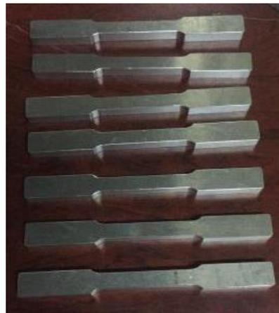
*Nota.* La figura representa las probetas finalizadas a medida normada.
