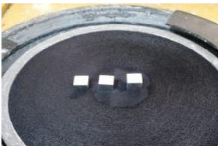
*Nota.* En la figura se muestra el pulido especular que se realizó a la muestra, para que esta tenga un área con menores imperfecciones.
