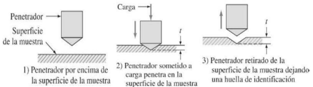
*Nota.* La figura muestra las etapas del ensayo de dureza. Tomado de *Fundamentos de la ciencia e ingeniería de Materiales*. (Vol. 4)(p.986), por Smith, W., & Hashemi, J. 2007, McGraw-Hill Education.
