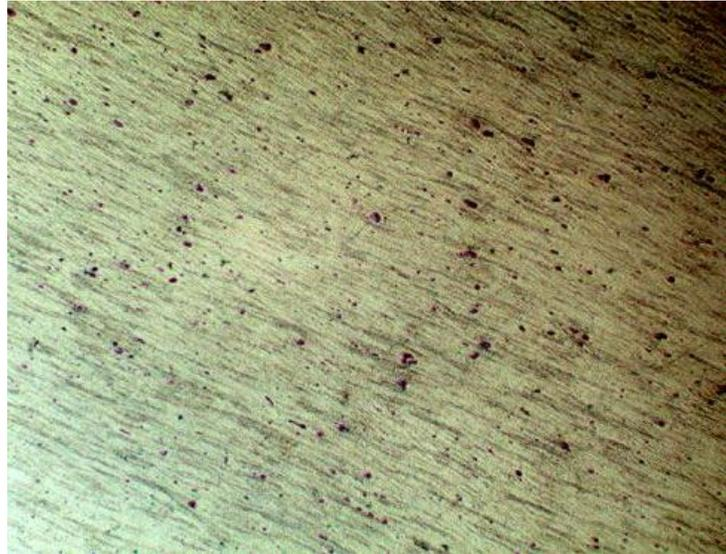
*Nota.* En la imagen se muestra una fotografía de la muestra sin tratamiento térmico vista con el microscopio con un aumento de 200X.
