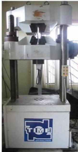
*Nota.* El gráfico muestra la máquina usada para el ensayo de tensión.
