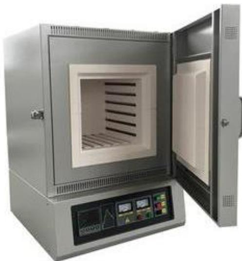
*Nota.* La figura representa el horno de mufla utilizado para el tratamiento térmico Normalizado. Tomado de *Diseño y construcción de un horno mufla para la realización de tratamientos Ingeniería en aceros* (p.1), por Monteros, L. 2015.
