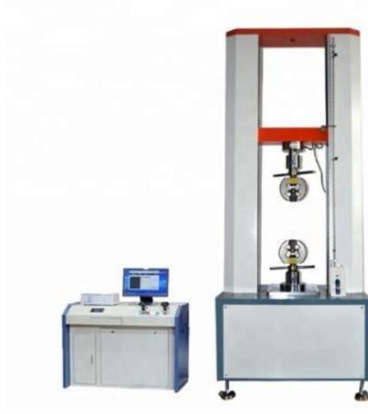
Nota. La figura muestra una máquina de tracción. Tomado de <https://spanish.alibaba.com/product-detail/300kn-universal-tensile-testing-machine-universal-tensile-compression-testing-machine-universal-testing-machine-price-1765800334.html>, por Máquina de Tracción. 2017. [Gráfico]. Alibaba
