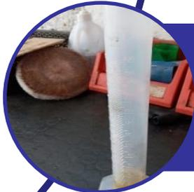
Probeta reglada de 250 ml, manguera de 5/16 y un neplo.
