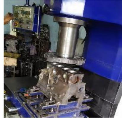
En el motor Nissan J15 se puede rectificar la superficie del block hasta 0.5 mm como afirma Nissan Motor CO. , LTD.(S.F) “El límite de rectificado de la superficie del block se encuentra restringido por el límite de rectificado de la superficie plana de la culata (A) y la superficie plana del block (B), el límite es  $A+B=2\text{mm}$  (0.0784in)” .
