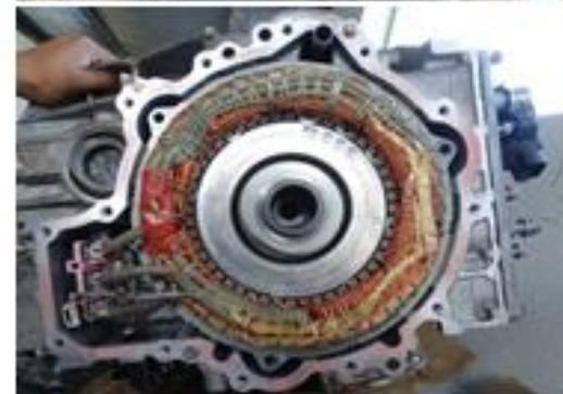
*Desmontaje de tapa de MG2*
