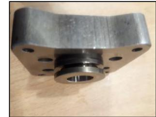
Monta el espaciador en el cuerpo del inyector considerando lo que el orificio de descarga del espaciador en los inyectores internacional se coloca en sentido contrario al conducto de salida del cilindro o cuerpo de inyector. (En los inyectores Caterpillar se colocan en el mismo sentido).
