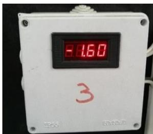
*Nota.* La figura permite visualizar la corriente que se empleó en el banco de pruebas para la primera descarga de la batería HV.
