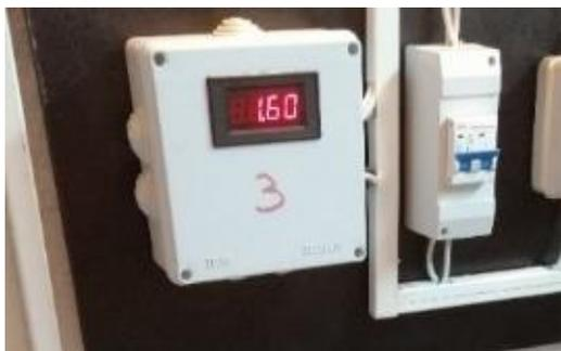
*Nota.* Esta figura muestra la corriente que se empleó en el banco de pruebas para la primera de la batería HV
