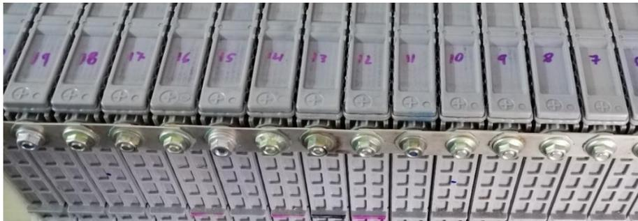
*Nota.* Esta figura indica el proceso de conexión en paralelo de las celdas que conforman la batería HV
