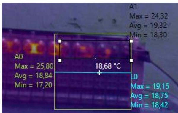
*Nota.* La figura muestra la temperatura promedio existente en la sección B una vez que las celdas se encuentran al 100% de su tensión nominal, el valor estimado es de 18,68°C.
