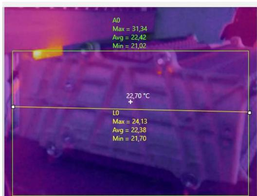
*Nota.* Esta figura denota la temperatura existente en la sección lateral una vez que las celdas alcanzaron el 30% de su tensión nominal, llegando a generar un valor térmico promedio de 22,70°C.
