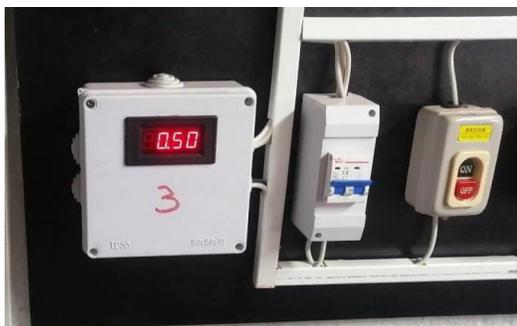
*Nota.* La figura muestra la corriente que se empleó en el banco de pruebas para la primera descarga de la batería HV.
