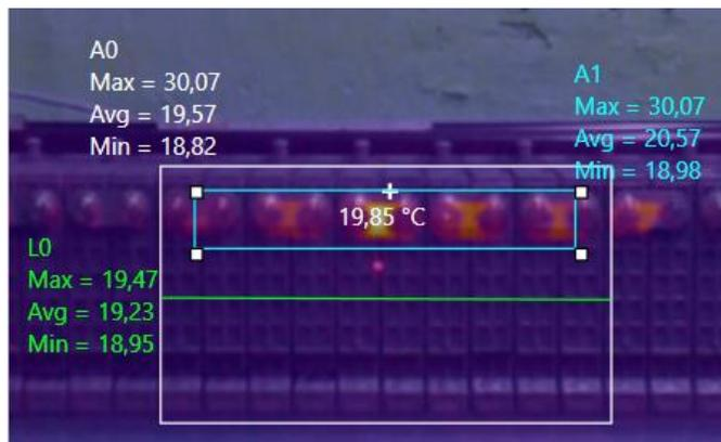
*Nota.* La figura indica la temperatura existente en la sección C una vez que las celdas se encuentran al 45% de su tensión nominal, con un valor promedio de 19,85°C.
