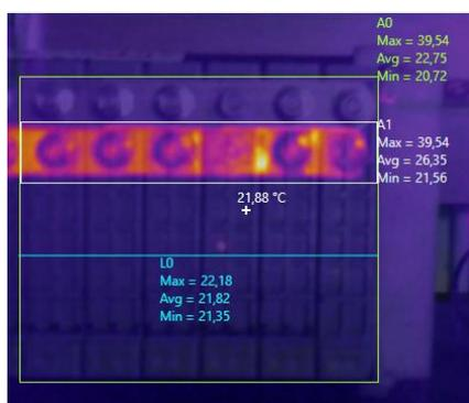
*Nota.* La figura muestra la temperatura promedio existente en la sección B una vez que las celdas llegaron al 90% de su tensión nominal, dicho valor corresponde a 21,88°C.
