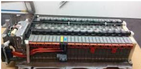
*Nota.* La figura representa una batería de alta tensión: (ElectronicaCar, 2019)
