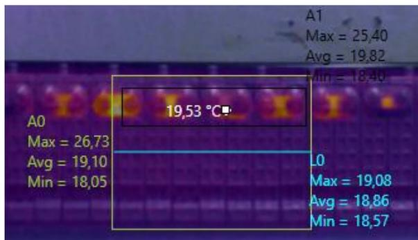
*Nota.* La figura determina la temperatura promedio existente en la sección C una vez que las celdas se encuentran al 100% de su tensión nominal, el valor estimado es de 19,53°C.
