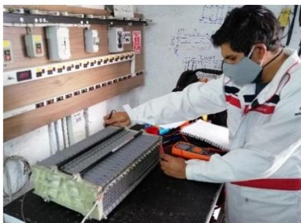
*Nota. En la imagen se observa el procedimiento de captación de valores iniciales de voltaje en cada una de las celdas.*
