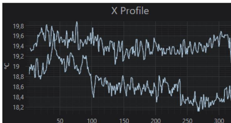
*Nota.* La gráfica nos indica la variación de temperatura que existe entre las rectas L0 y L2, conociendo que L2 se encuentra en la parte delantera de la figura y L0 en la parte del fondo.
