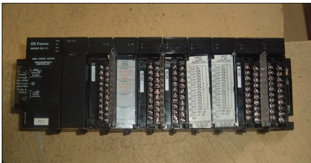
Figura. 2.51. PLC GE FANUC
