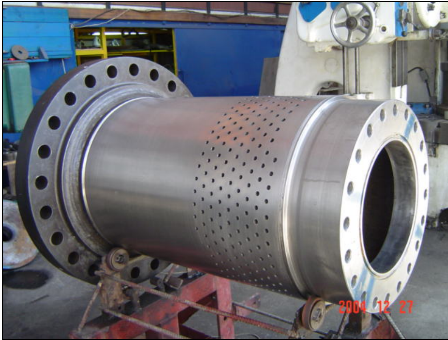
Figura. 2.18. Desmontaje de Válvula Polyjet
