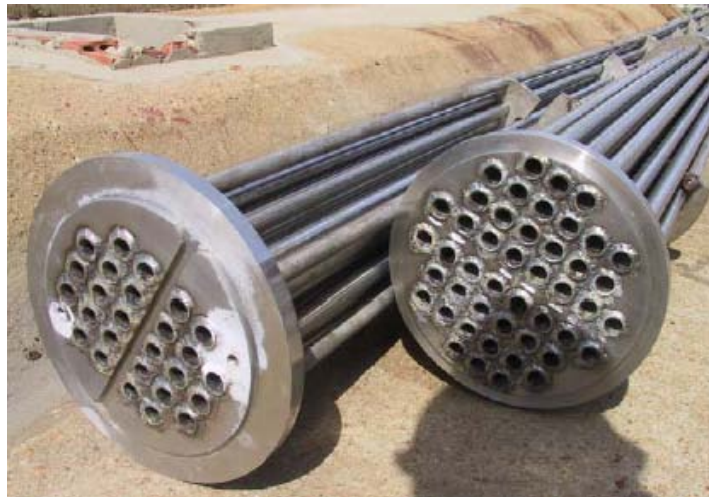
Figura 3.20: Espejos de intercambiadores de calor
