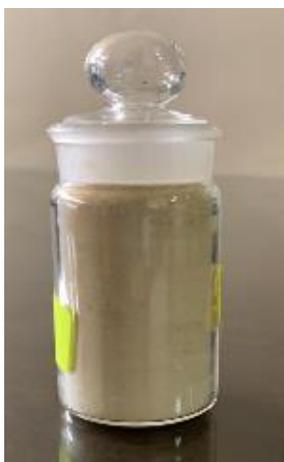
*Nota.* El gráfico muestra el resultado de la síntesis del polímero poly(*p*-phenylene-terephthalamide) (PPTA), después del secado, molienda y tamizado.
