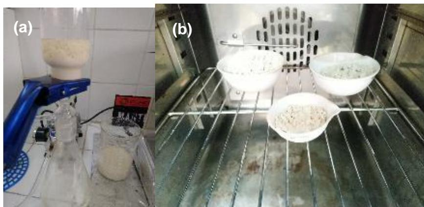
*Nota.* (a) Sistema de filtración Glasco para el proceso de secado, y (b) secado del polímero en estufa a 100°C.
